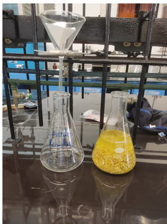
Figura 3.3. Filtraciones por gravedad para los lavados previos realizados a las extracciones ultrasónicas.
