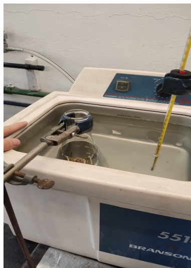
Figura 5.1. Sistema de extracción utilizado para la obtención de compuestos fenólicos de las cáscaras de la naranja vía ultrasonido.
