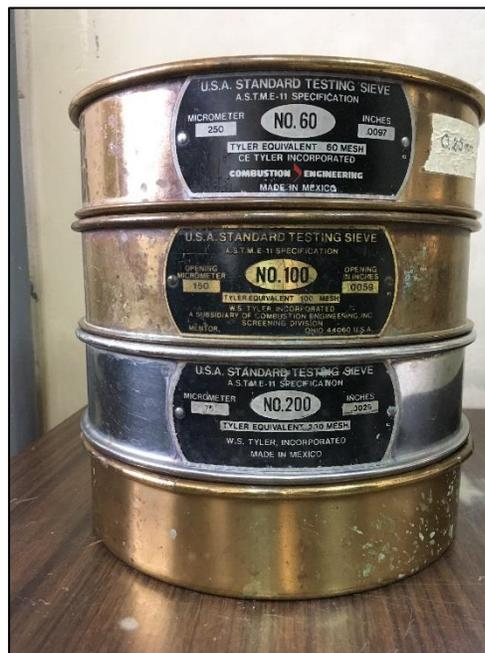
**Figura 4.** Tamices utilizados en el proceso de separación granulométrica de las cenizas del volcán Turrialba. Se utiliza un arreglo de tres tamices y un fondo, siendo el orden descendiente de #60, #100 y #200.
