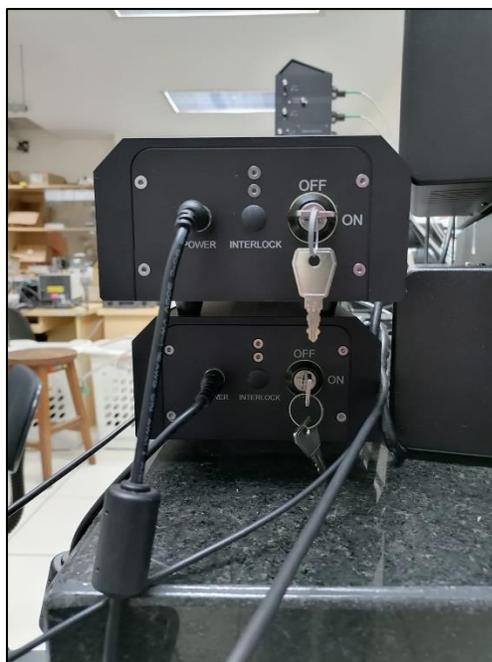
Figura 9. Parte trasera de los láseres. Accionamiento manual por medio de llave.
