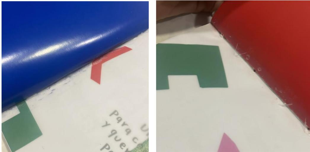
*Fig 91. Prueba de impresión 1, defectos de empastado (2022)*
