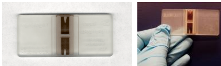
Figura 45. Hematocitómetro requerido para el conteo de células viables. Imagen cortesía de http://www.hausserscientific.com/reichertbrightline.htm .
