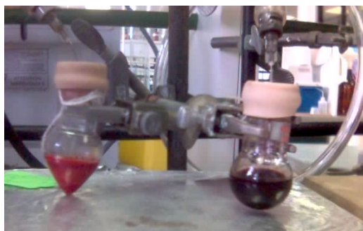
Figura 65. Reacciones de acoplamiento entre 2-bromo-1,4-naftoquinona y 1-adamantilamina en dimetoxietano (izquierda) y acetonitrilo (derecha).
