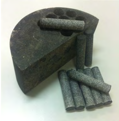
(a) Exemplos de corpos de prova de MAF (b) Etapa de extração dos corpos de prova
