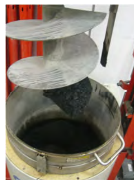
(b) Hélice interna do equipamento
