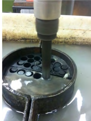
(a) Exemplos de corpos de prova de MAF (b) Etapa de extração dos corpos de prova
