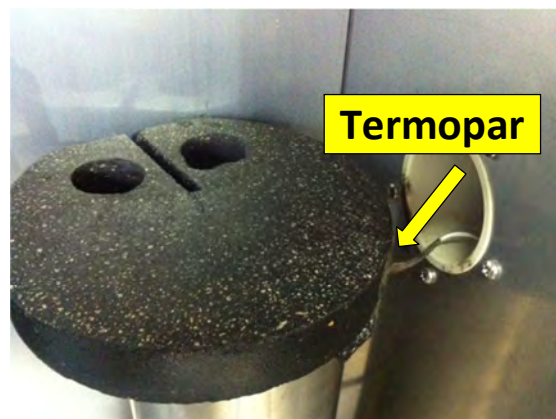
Figura 3.7. Amostra para montagem do termopar neste estudo.
