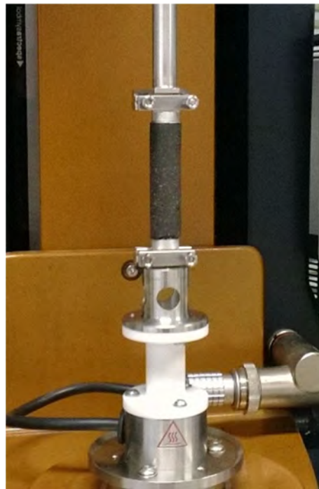
Figura 3.6. Corpo de prova acoplado ao DSR e pronto para ser ensaiado nesta pesquisa.
