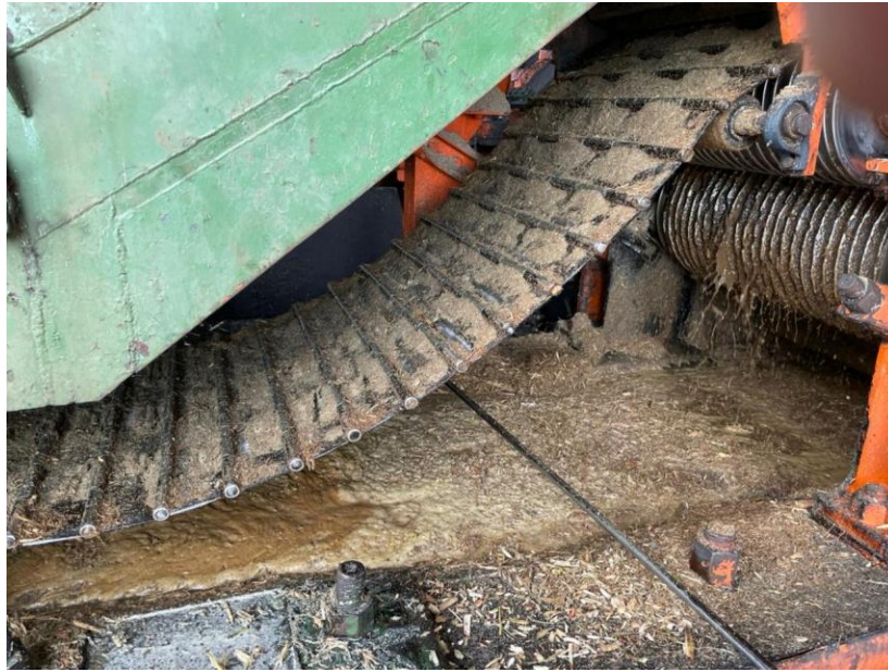
Anexo 13: Proceso de extracción de jugo en los molinos, el jugo estancado se integra al proceso.
