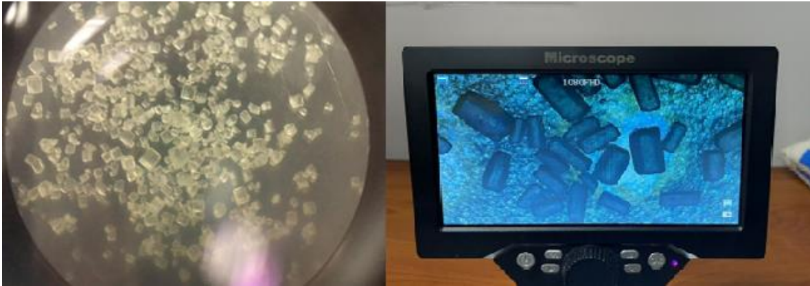
Figura 18: Imagen comparativa de granos de azúcar en forma normal (cuadrada) producidos por un ingenio azucarero costarricense y los granos de azúcar del lote consecutivo 199 del ingenio El Porvenir tratado enzimáticamente donde se puede observar elongación del cristal. Fuente: propia.
