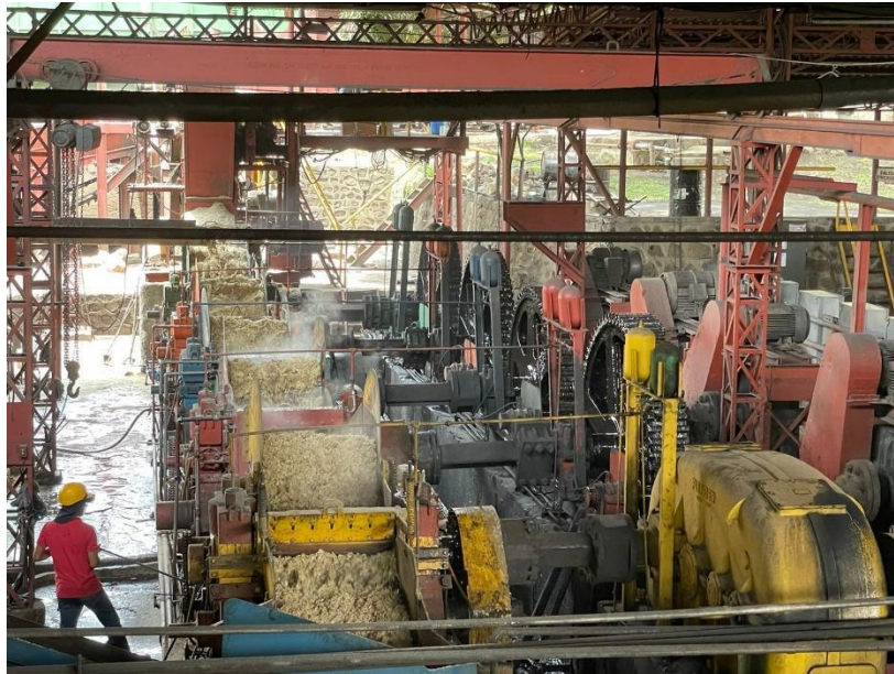
Figura 7: Etapa de extracción del jugo por medio de molinos en el Ingenio El Porvenir. Fuente propia.
