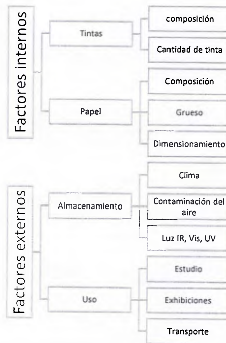
FIGURA 2-1. FACTORES EXTERNOS E INTERNOS QUE PROPICIAN LA PROPAGACIÓN DEL DETERIORO, TOMADO DEL ICN 44 .
