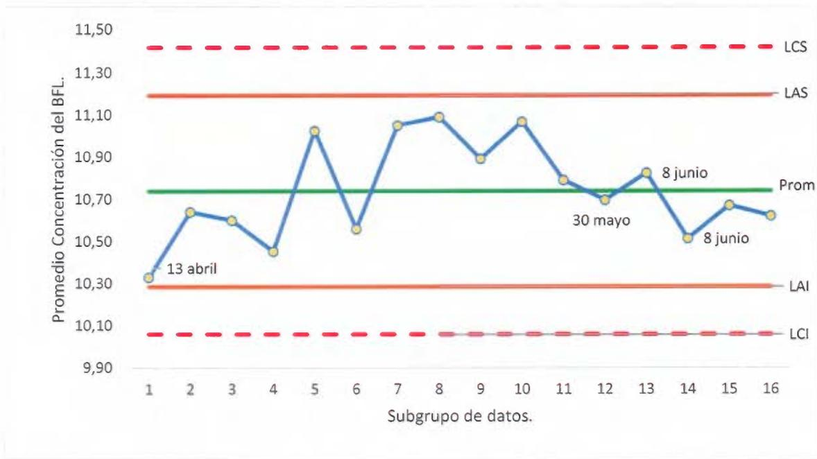
**Figura 20:** Carta de control del promedio  $\bar{X}$  para los BFL de nitrito. Se indica un Límite de Control Superior (LCS), Límite de Advertencia Superior (LAS), Promedio central, Límite de Advertencia Inferior (LAI) y Límite de Control Inferior (LCI).
