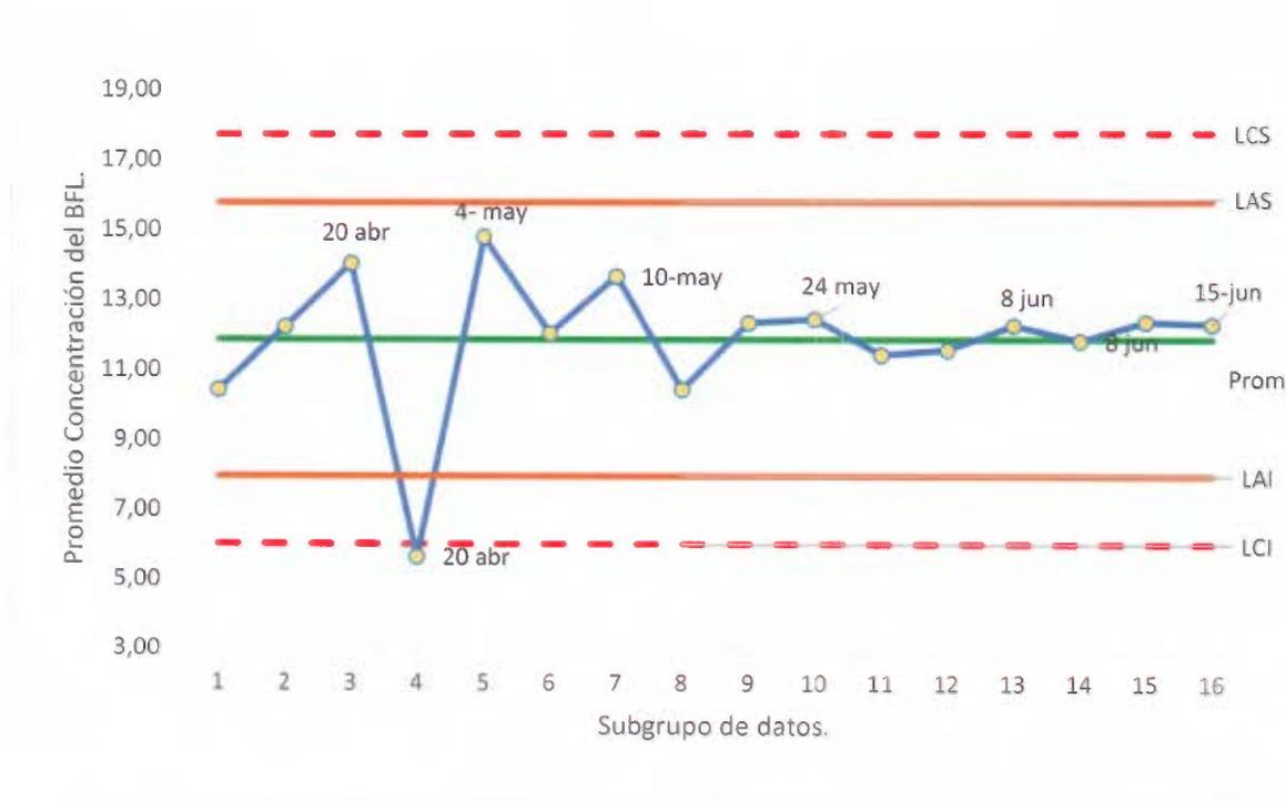
**Figura 22:** Carta de control del promedio  $\bar{X}$  para los BFL de amonio. Se indica un Límite de Control Superior (LCS), Límite de Advertencia Superior (LAS), Promedio central, Límite de Advertencia Inferior (LAI) y Límite de Control Inferior (LCI).
