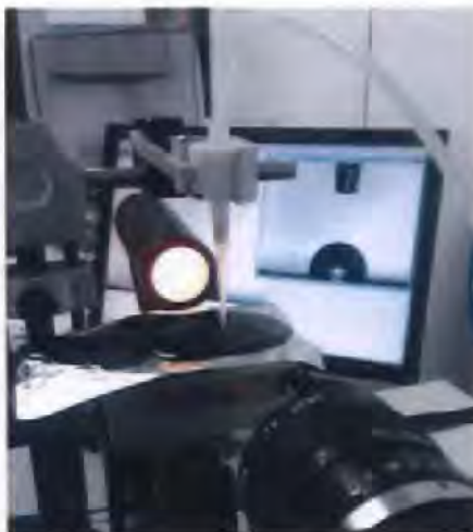
Fig. 7. Implementación del goniómetro en la medición del ángulo de contacto entre el asfalto (superficie sólida) y un líquido de prueba
