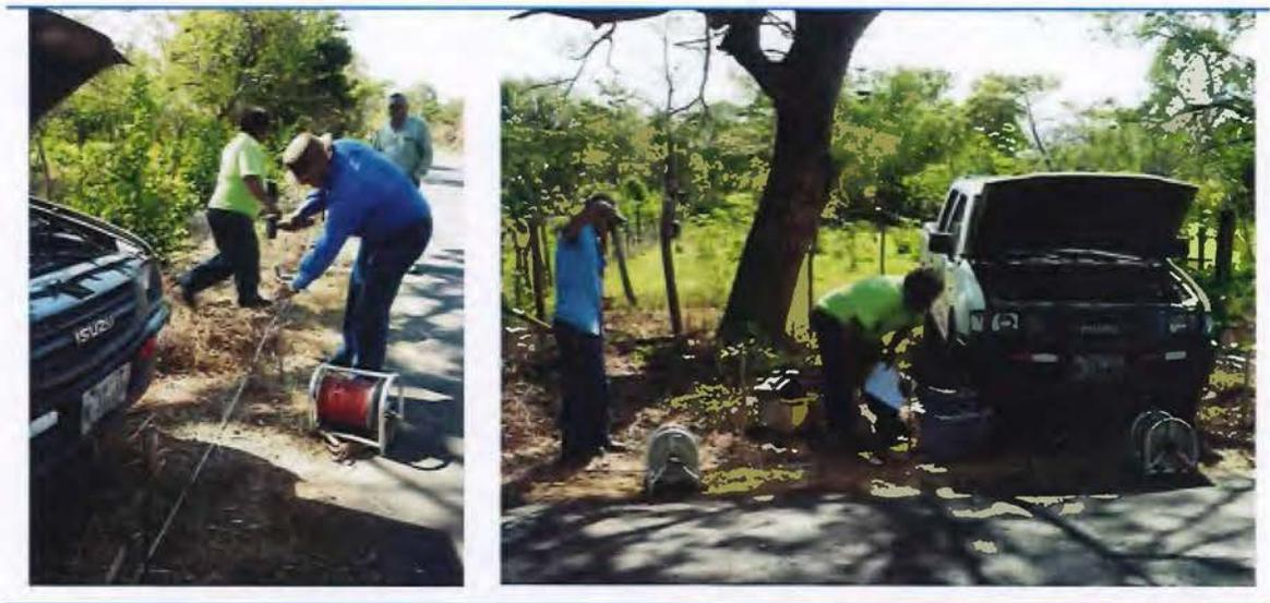
Figura 5.3 Realización de Sondeos eléctricos verticales.
