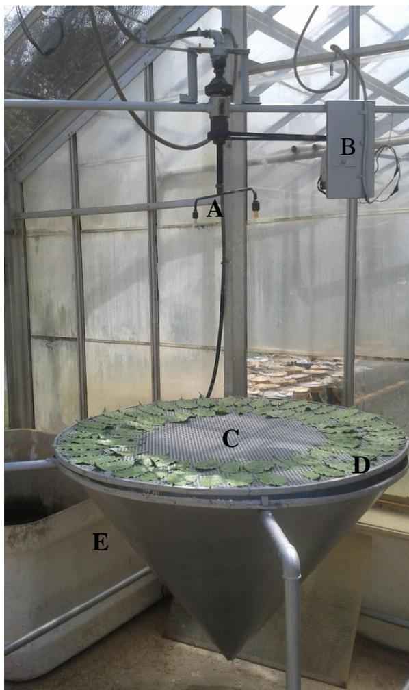
**Figura 1.** Simulador de chuva utilizado no experimento. (A) Bicos de simulação de chuva. (B) Controle e ajuste velocidade dos bicos. (C) Mesa de pulverização. (D) Folhas de café. (E) Reservatório de água e controle da pressão.
