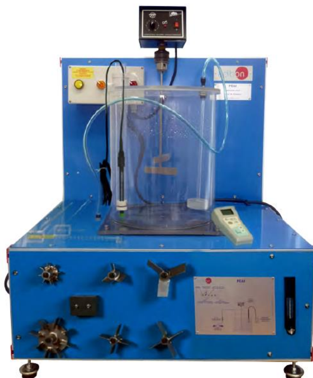
Figura 31. Esquema del módulo de tanque agitado con aireación del fabricante Edibon (Edibon, 2018).
