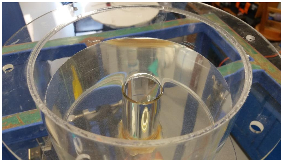
Figura 60. Rebalse de agua en la entrada a la columna.
