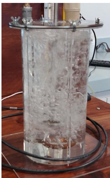
Figura 68. Ausencia de vórtice a una velocidad de agitación de 1200 revoluciones por minuto.
