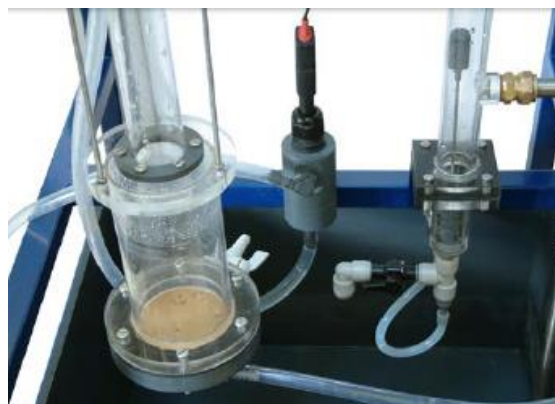
Figura 12. Detalle del depósito inferior del módulo de pared húmeda del fabricante Armfield (Armfield, 2018).
