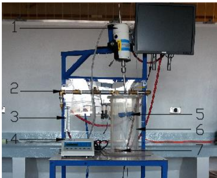
Figura 26. Módulo de tanque agitado con aireación en su estado inicial del Laboratorio de Ingeniería Química.
