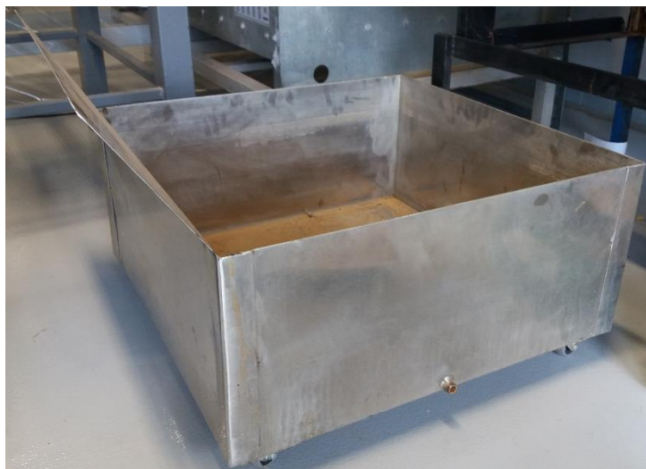
Figura 13. Depósito de agua de la torre de enfriamiento de tiro inducido.
