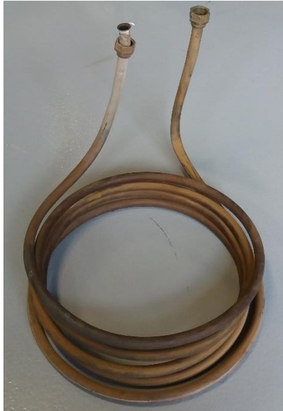
Figura 18. Serpentín que utilizó la torre de enfriamiento de tiro inducido.
