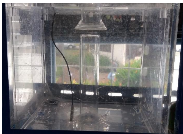
Figura 4. Detalle del depósito inferior de la torre de pared húmeda.
