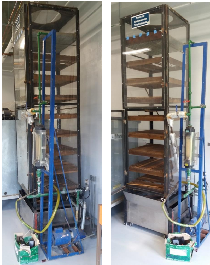
Figura 14. Torre de enfriamiento de tiro inducido.
