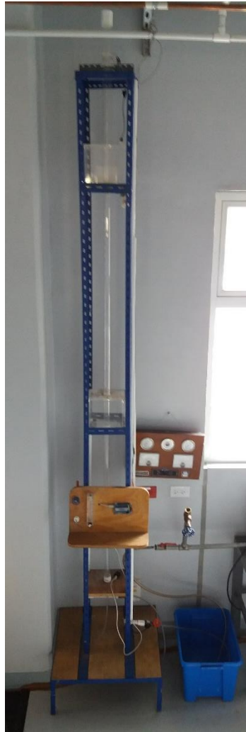
Figura 2. Torre de pared húmeda.
