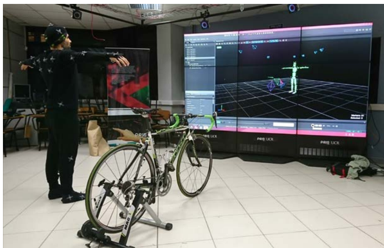
Figura 2.2: Sistemas de captura de movimiento con marcadores pasivos. (Elaboración propia)
