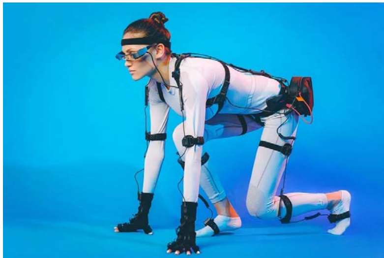
Figura 2.8: Sistemas de captura de movimiento magnéticos. (Azosensors, 2020)
