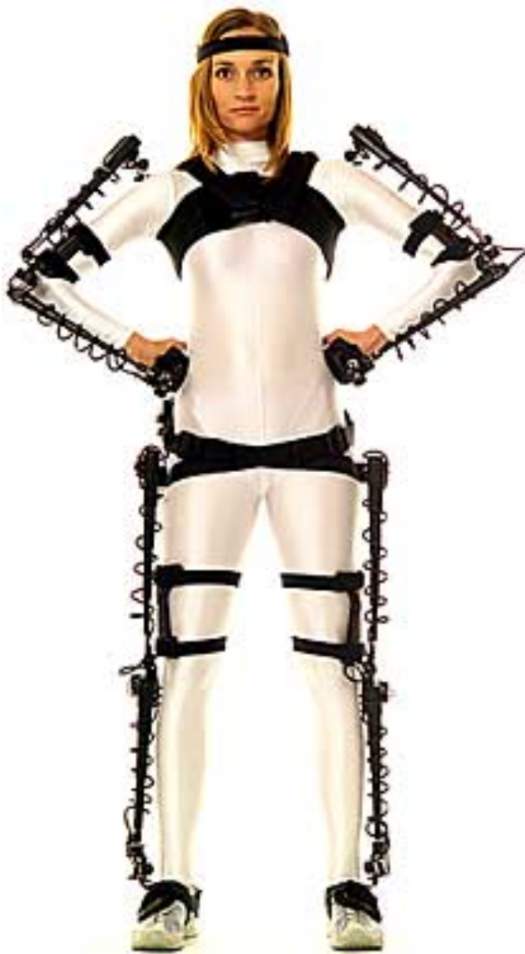
Figura 2.7: Sistemas de captura de movimiento mecánicos. (Metamotion, 2022)
