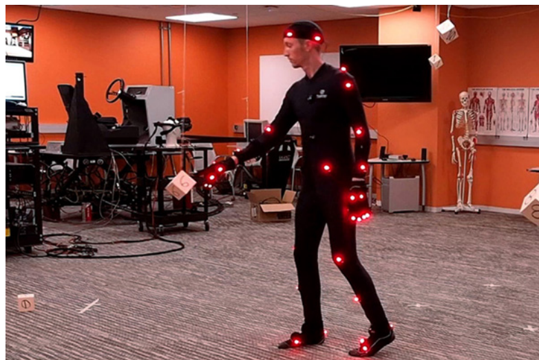
Figura 2.3: Sistemas de captura de movimiento con marcadores activos. (Pre-mo, 2018)
