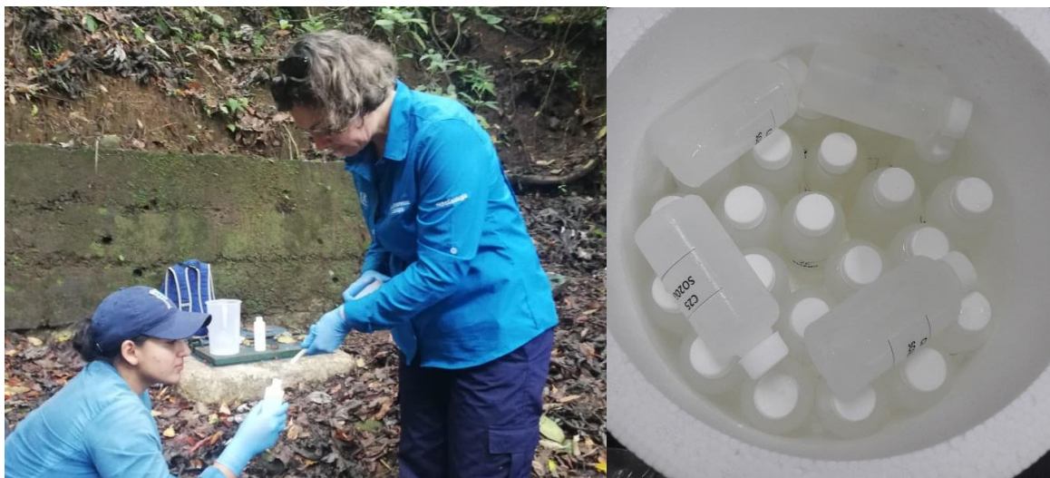
Figura 13. Preparación de las muestras de agua subterránea. La imagen izquierda muestra el filtrado de las muestras en el campo, la imagen derecha indica el almacenamiento de las muestras en la hielera de estereofón para ser enviadas al laboratorio.
