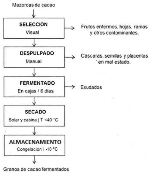
Figura 20. Secuencia de operaciones empleada para el desarrollo de las fermentaciones de cacao.
