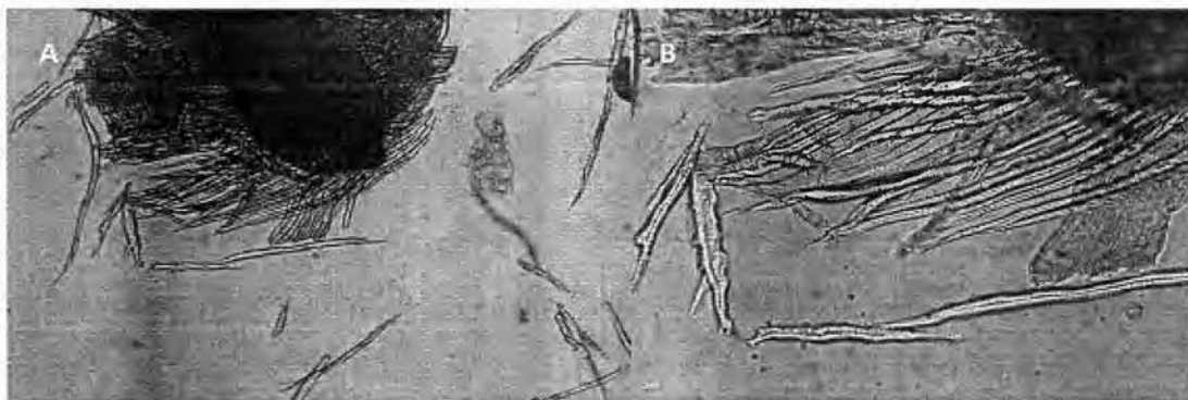
Figura 5. 11 Pergamino de café sometido a ultrasonificación a una potencia de 44 \text{ W/cm}^2 por 5 minutos y posteriores incubaciones enzimáticas con celulasas. (A) Incubación por 5 horas, (B) Incubación por 24 horas. 10X
