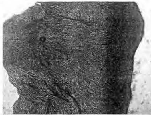
Figura 5.6 Vista microscópica de pergamino de café luego de un autoclavado en ácido fosfórico al 1% por 45 minutos. 4X.
