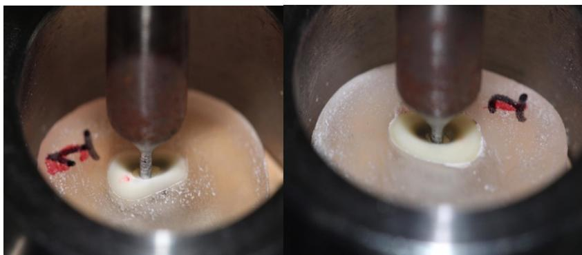
**Figura 16.** Proceso de a la máquina Tinius Olsen H10KS del laboratorio de Prostodoncia de la UCR para someterlos al Ensayo Mecánico Laboratorial de Cizallamiento por Extrusión (Push-Out), en las muestras sin y con microscopio
