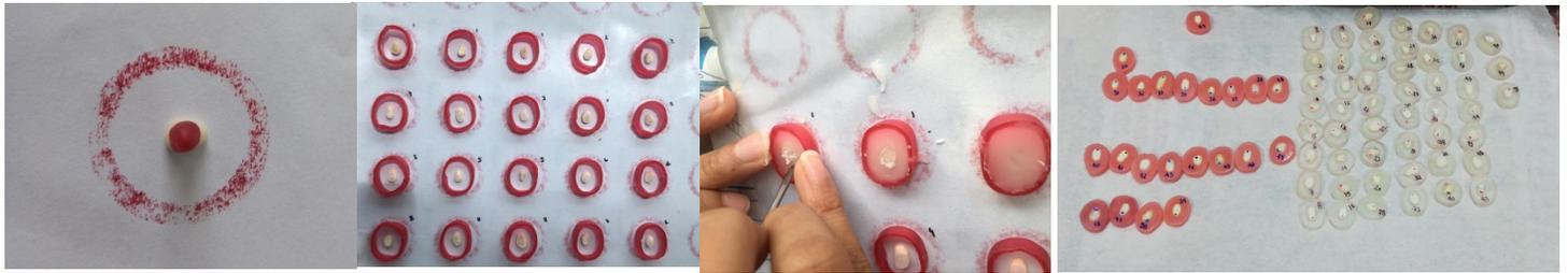
**Figura 14.** De izquierda a derecha diámetro de las muestras, se montaron las muestras en una hoja adhesiva, se encajonaron con cera y se bloqueó la zona de desalajo con cera utility para luego vaciar el acrílico de autocurado y que las muestras quedarán retenidas en el acrílico.
