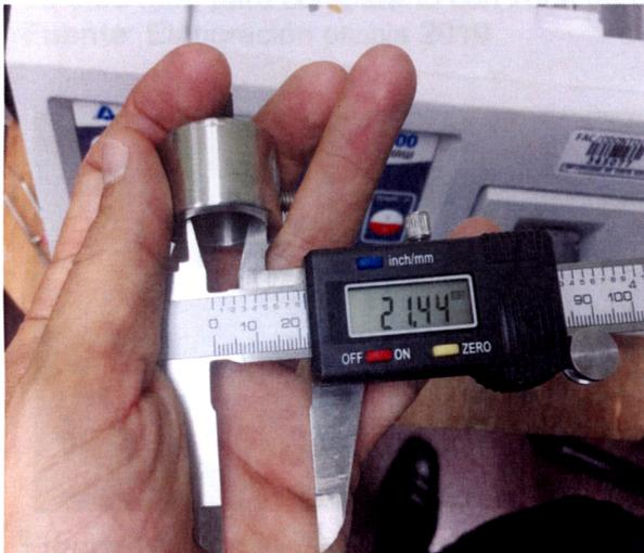
**Figura 13.** Medida del diámetro para las pruebas donde irá el amortiguador y las muestras para las pruebas de push out
