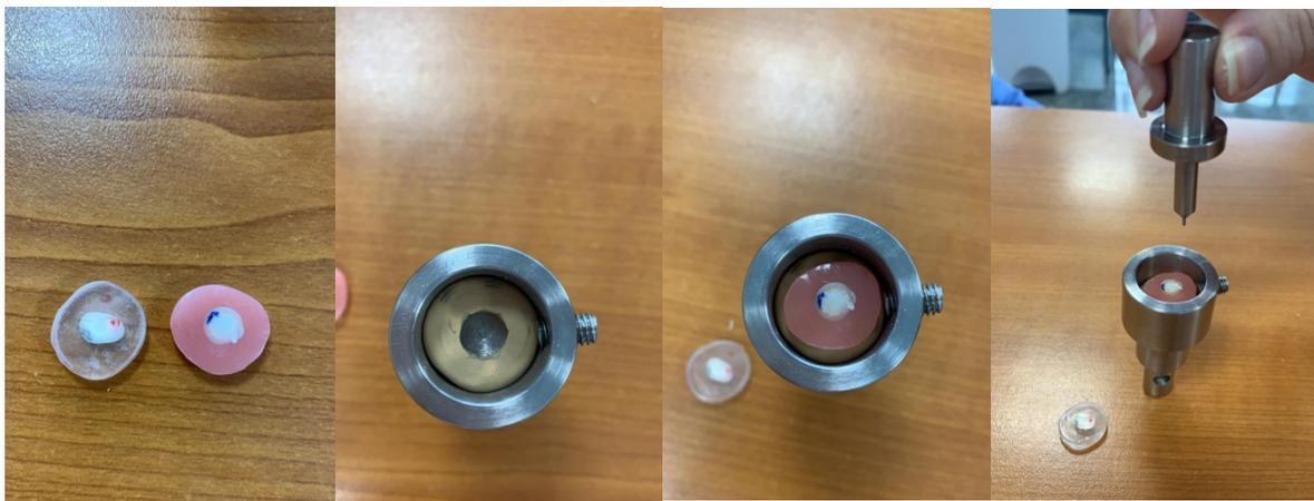
**Figura 15.** De izquierda a derecha muestras retenidas en acrílico, colocación de espaciador realizado en putty, para brindar amortiguado al desalajo, presentación de la muestra sobre el espaciador, para verificar la posición y el tamaño, presentación del pin diseñado para la prueba de 0,93 mm, para compararlo con zona de desalajo.
