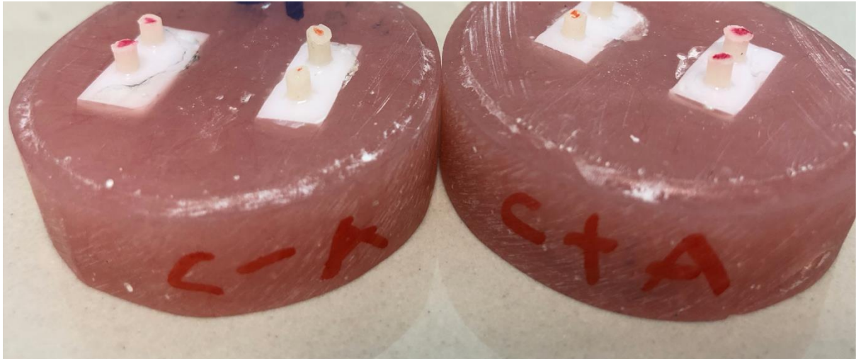
Figura 3. Muestras de resina cementadas en los bloques de circonio (sin y con adhesivo, respectivamente) utilizando el imprimador Clearfil Ceramic Primer Plus
