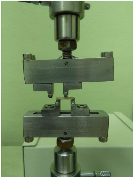
Figura 3. Prueba de flexión uniaxial de tres puntos.
