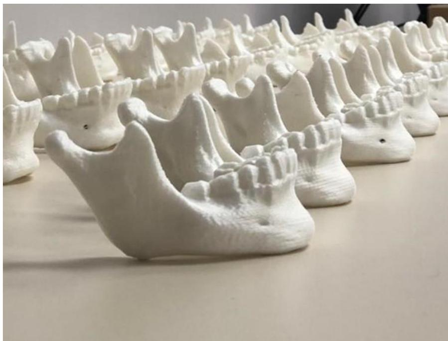
Figura 8. Impresiones 3D de mandíbulas terminadas y limpias.
