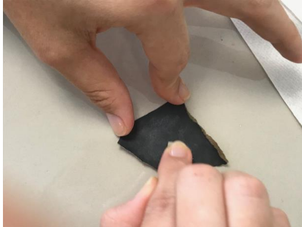
Ilustración 1. Pulido digito-manual de muestra en lámina de disilicato de litio.
