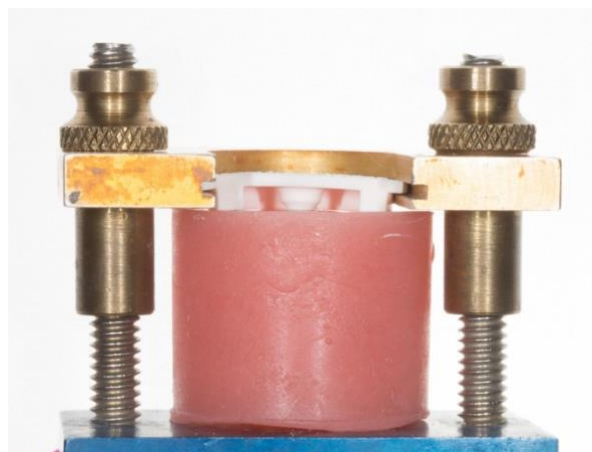
Ilustración 15. Base para confección de cilindros de cemento
