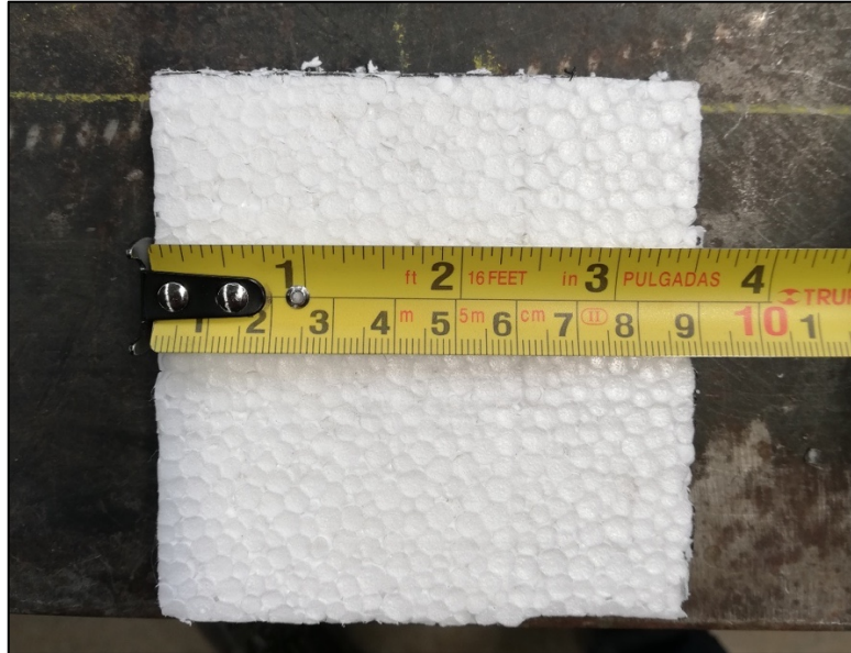
Figura 13. Detalle de lámina de poliestireno de 9x9 cm
