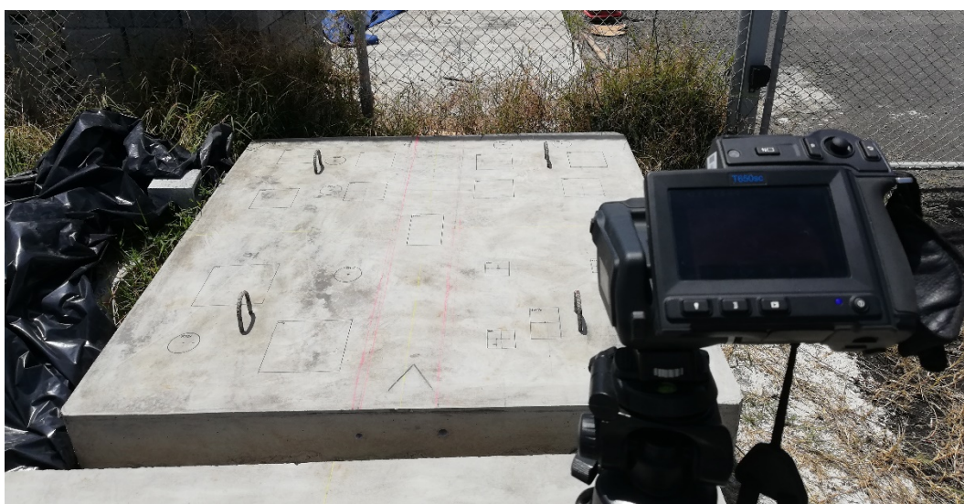
Figura 40. Aplicación del ensayo de termografía infrarroja en la losa 1
