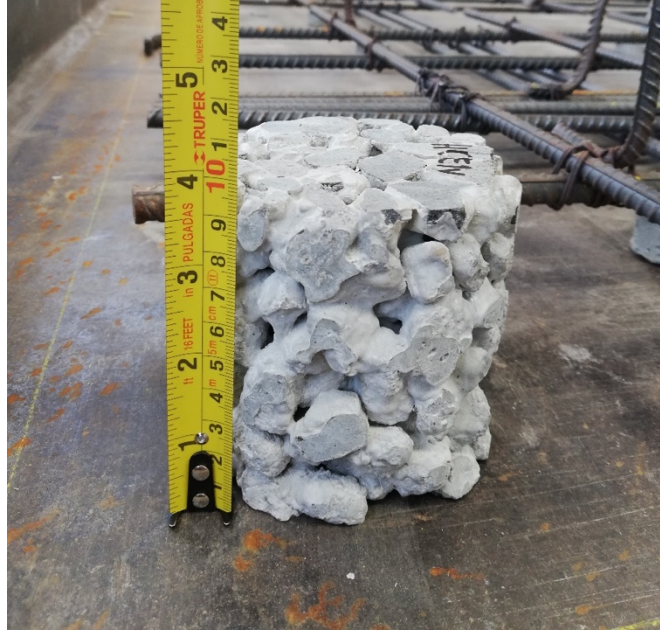
Figura 16. Detalle de cilindro de concreto permeable de 10x10 cm
