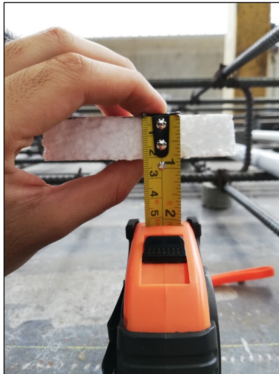
Figura 14. Detalle del espesor típico de 20 mm de las láminas de poliestireno
