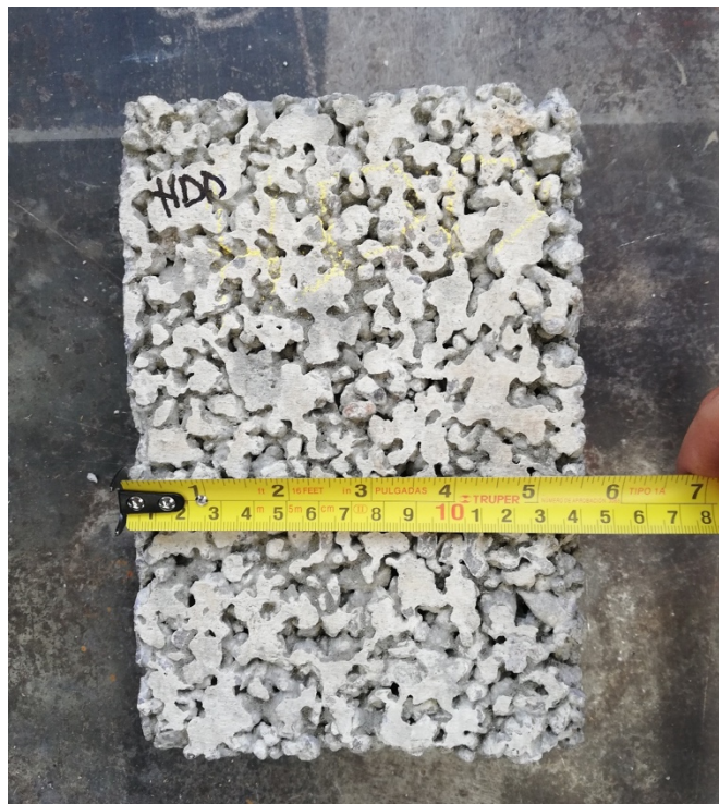
Figura 17. Detalle de bloque de concreto permeable utilizado (Defecto HDD)
