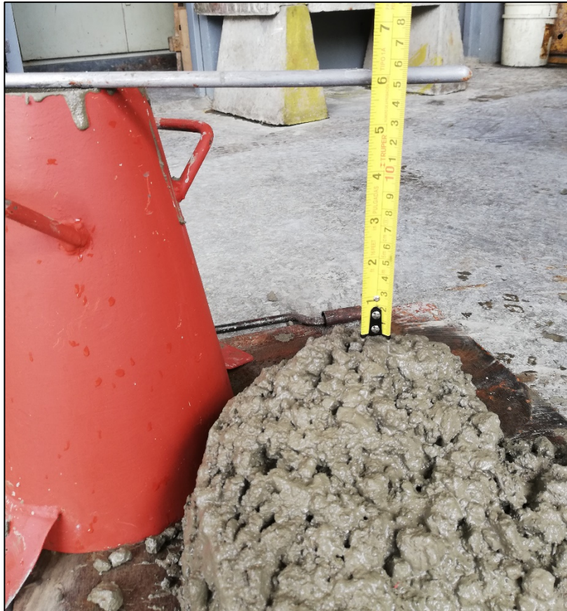
Figura 31. Revenimiento del concreto
