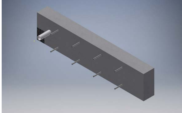
Figura 241. Perspectiva 3D de la sección D de la Losa 1 mostrando el refuerzo y los defectos que debería identificar el método para el escaneo lineal No. 63
