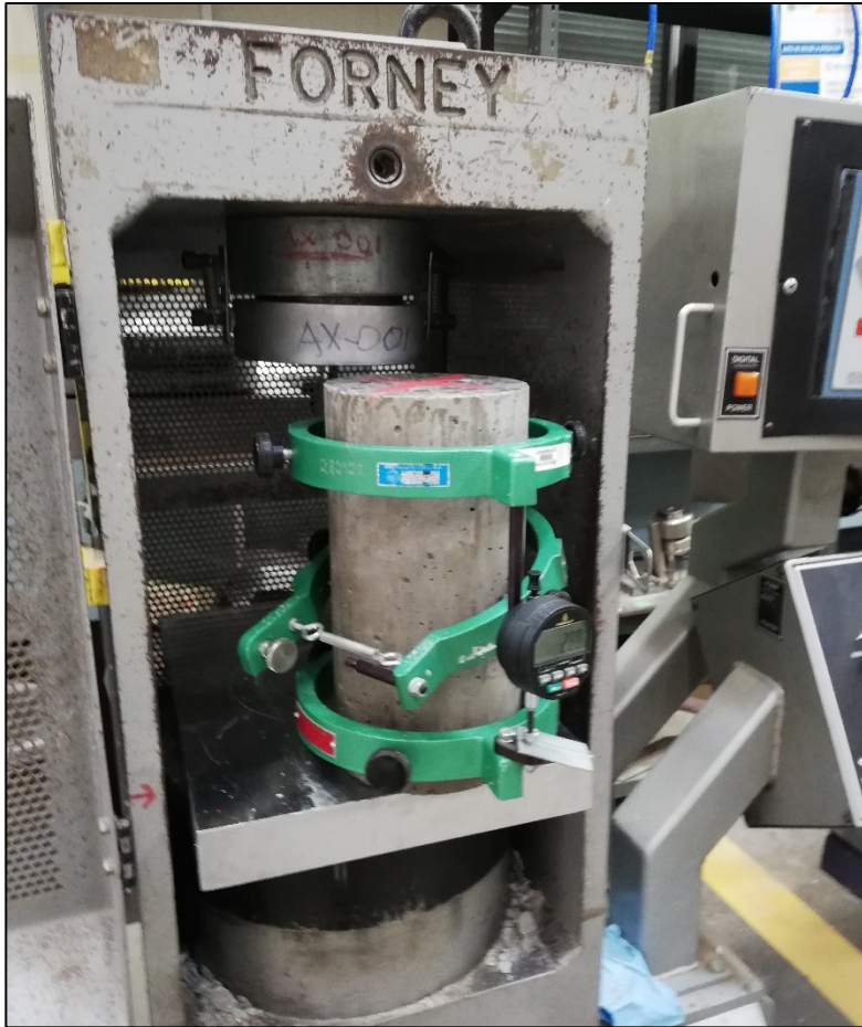
Figura 34. Cilindro No. 9 sometido a ensayo de módulo de elasticidad
