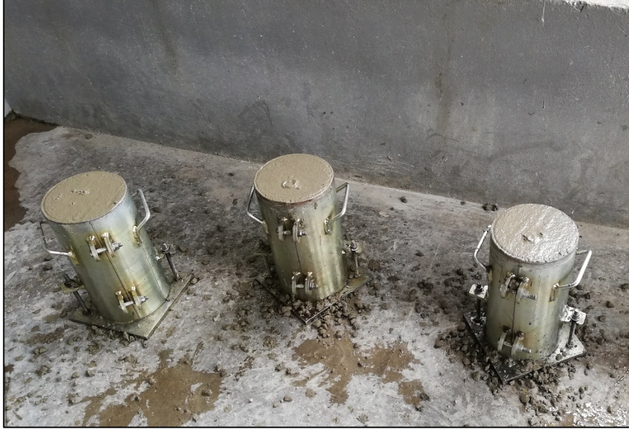
Figura 32. Elaboración de probetas de 15x30 cm
