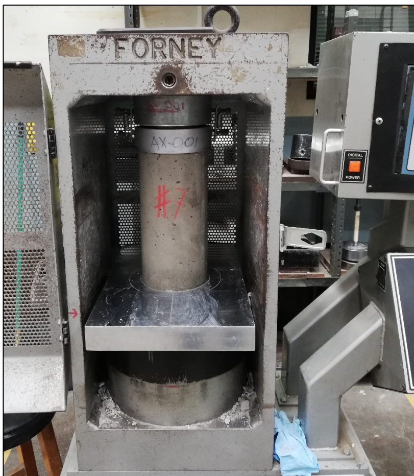
Figura 33. Cilindro No. 7 sometido a ensayo de resistencia a la compresión
