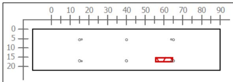
Figura 233. Sección transversal correspondiente al escaneo lineal No. 60 de la Losa 1 (Defectos: VCE2. Refuerzo superior: varillas No. 4 @ 25 cm. Refuerzo inferior: varillas No. 4 @ 25 cm)
