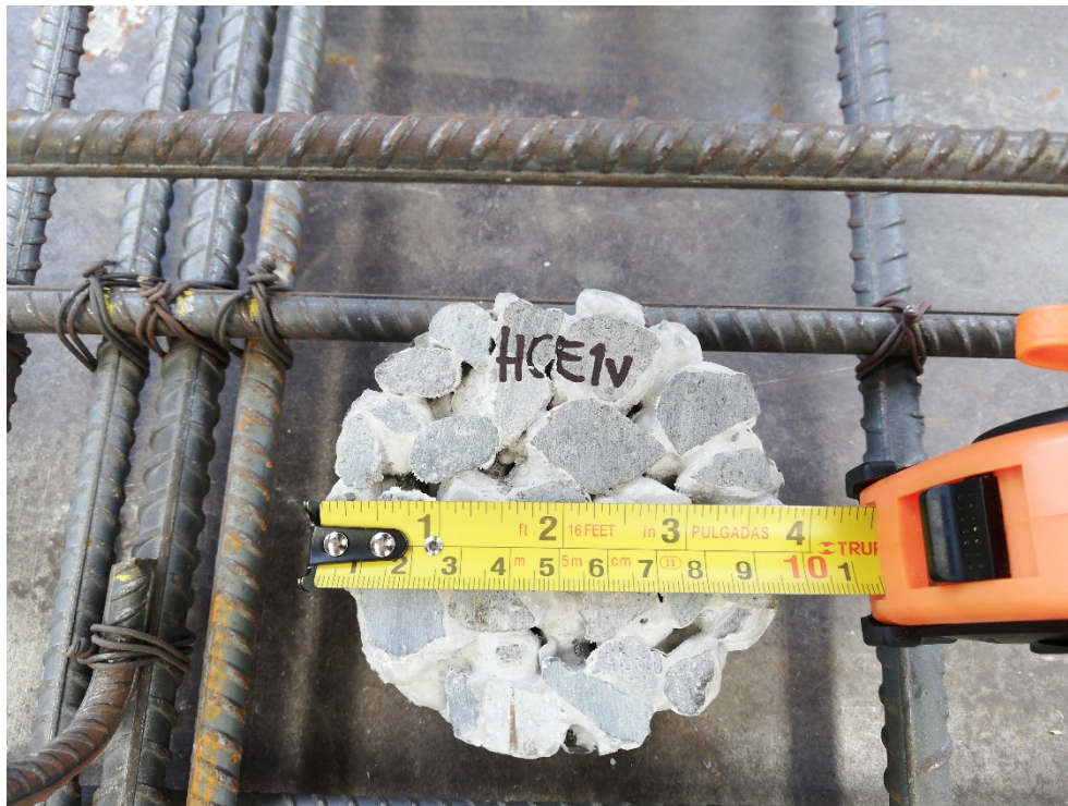
Figura 15. Detalle del diámetro típico de los cilindros de concreto permeable
