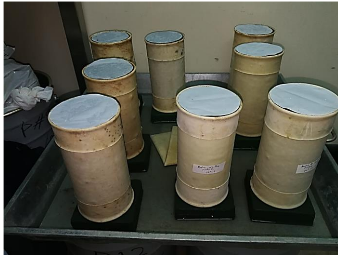
Figura 15. Humedecimiento de los especímenes
