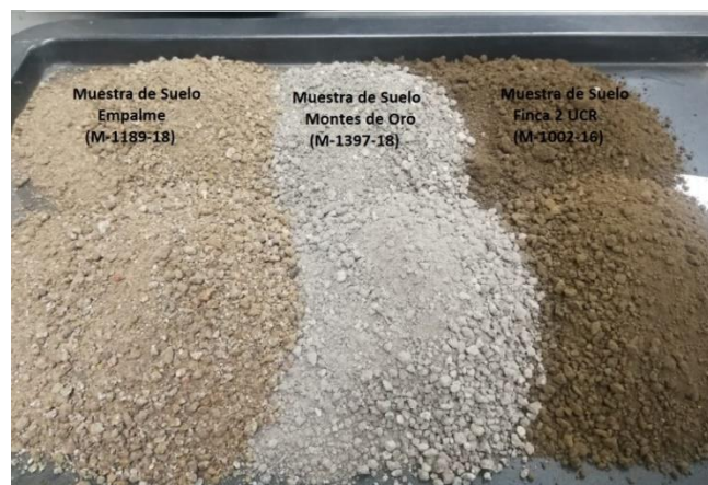
Figura 11. Muestras pasando malla #4 los tres suelos en estudio
