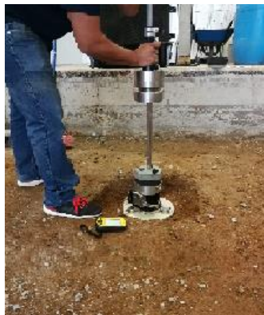
Figura 24. Ejecución del ensayo LWD
