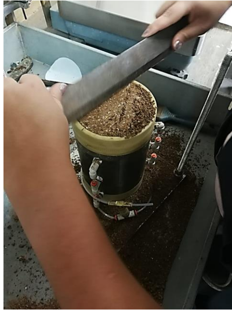
Figura 14. Enrasado del espécimen de suelo
