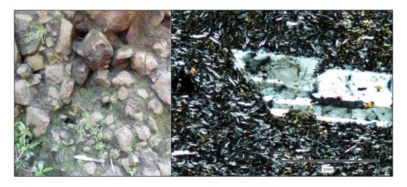
Figura 3.26: Autobrecha al costado de Planta Eléctrica Belén y sección delgada.
