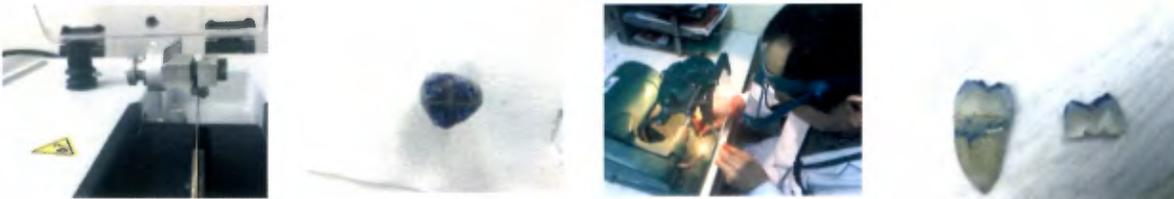
**Figura 4. Proceso de corte de las piezas dentales.** A. Recortadora Isomet 1000 con el inicio del corte transversal. B. Pieza dental con el corte transversal. C. Corte horizontal de la pieza dental D. Muestra con las dos porciones.
