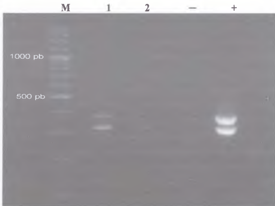
Fig. 2. PCR del ADN de EPEC obtenido de las concentraciones 1,5 \times 10^4 y 1,5 \times 10^3 bacterias/ml sembradas en caldo EC M) marcadores, 1) 1,5 \times 10^4 , 2) 1,5 \times 10^3 , +) EPEC eae +, bfp +, -) H 2 O destilada estéril
