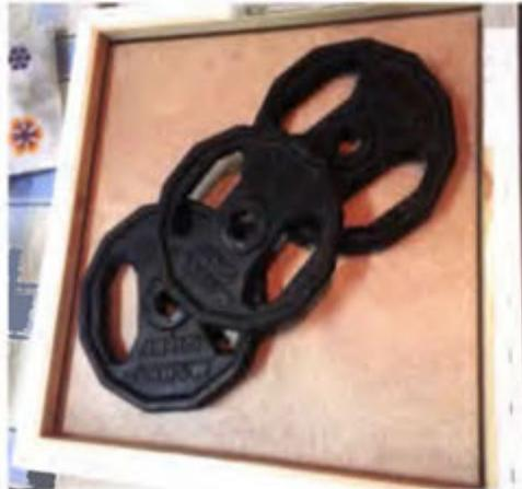
*Figura 65.* Peso para fijar refuerzo. Se deja varias horas con un peso encima para garantizar que quede bien fijo.
