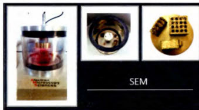
Figura 8. Equipo para SEM en proceso de recubrimiento. Medición de campo para las muestras. Muestras recubiertas con oro.
