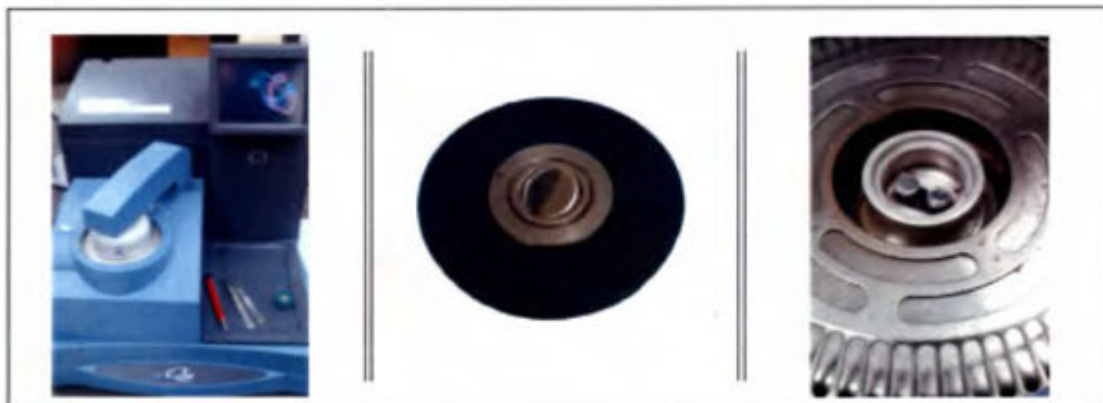
Figura 6. Equipo para DSC. Muestra dentro de la celda. Muestras listas para DSC.
