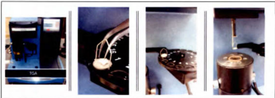
Figura 7. Equipo para TGA. Proceso de colocación de la muestra en la celda.
