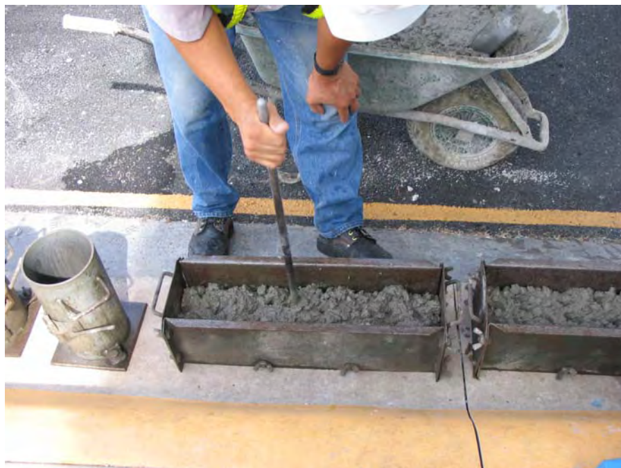
Fotografía 5.21. Fabricación de las vigas y cilindros de prueba (31/08/05)
