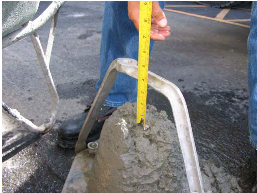
Fotografía 5.15. Medición de revenimiento sin aditivos (31/08/05)
