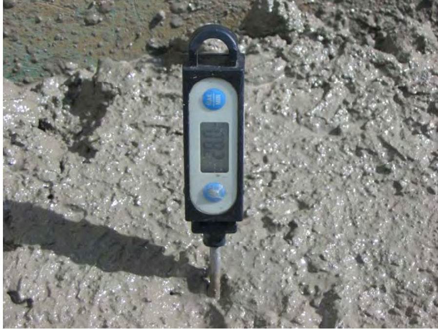
Fotografía 5.16. Medición de la temperatura (31/08/05)
