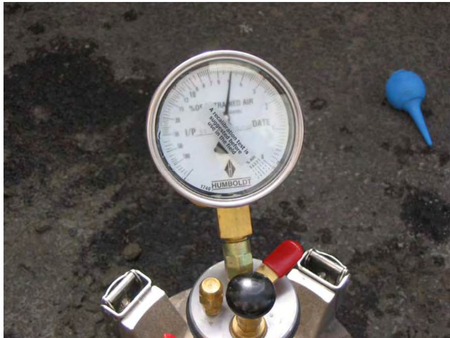
Fotografía 5.20. Cinco por ciento de contenido de aire (31/08/05)
