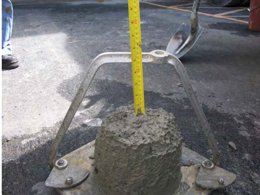
Fotografía 5.18. Revenimiento con aditivos (31/08/05)
