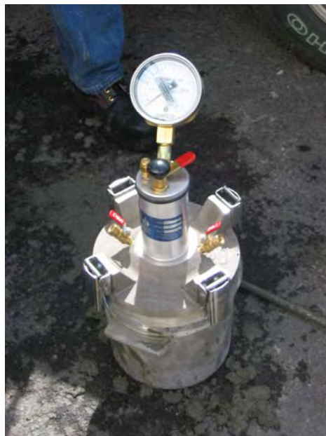
Fotografía 5.19. Medición del contenido de aire (31/08/05)
