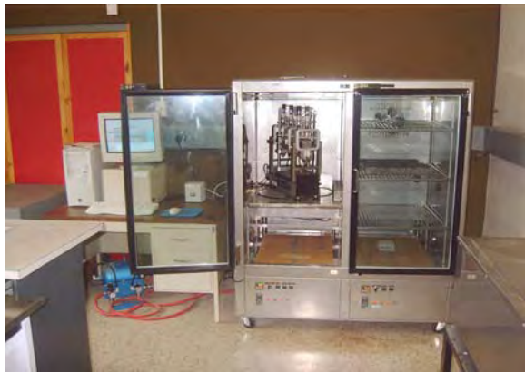
Figura 4.3. Cámara térmica y equipo de fatiga.
