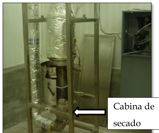
Figura 3.4. Secador con circulación de aire a través del sólido, planta piloto del CITA, Universidad de Costa Rica. (Centro de Investigación en Tecnología de Alimentos, s.f).
