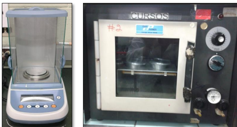
Figura 3.2. Balanza analítica (a), estufa de humedad (b) utilizadas para la determinación de humedad de las muestras. (Fotografía tomada por Dania Cisneros, 2017)
