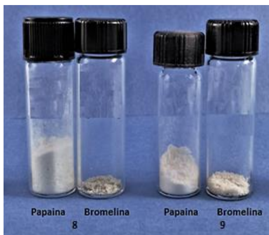
Figura 3.20 Recuperación de colágeno hidrolizado de pruebas preliminares después de segundo tratamiento enzimático utilizando bromelina o papaína.
