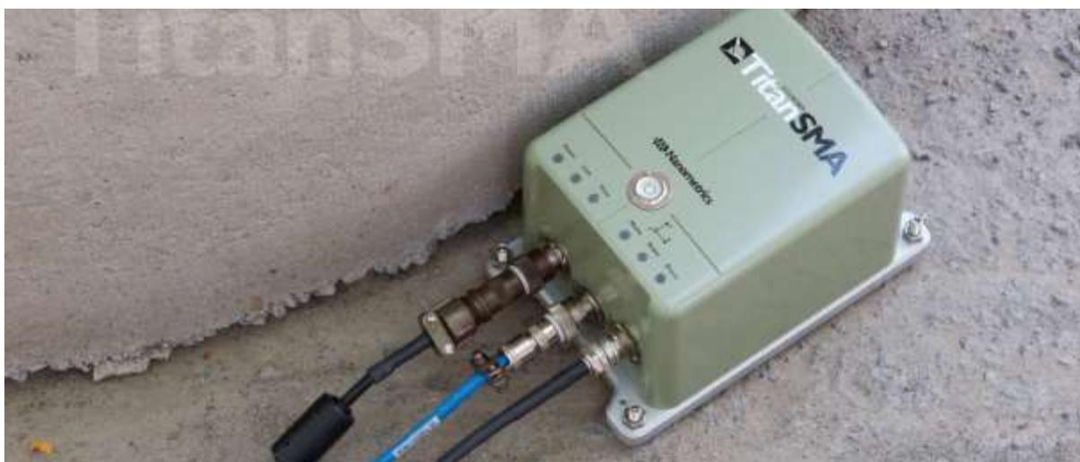
**Figura 21.** Acelerógrafo TitanSMA para medir vibraciones ambientales.
