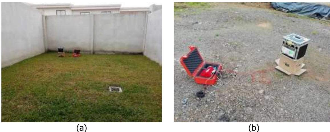
**Figura 23.** Medición de la frecuencia del suelo con el sismógrafo Lennartz (a) Zona posterior de la vivienda (b) Punto cercano a la propiedad donde se ubica la vivienda.
