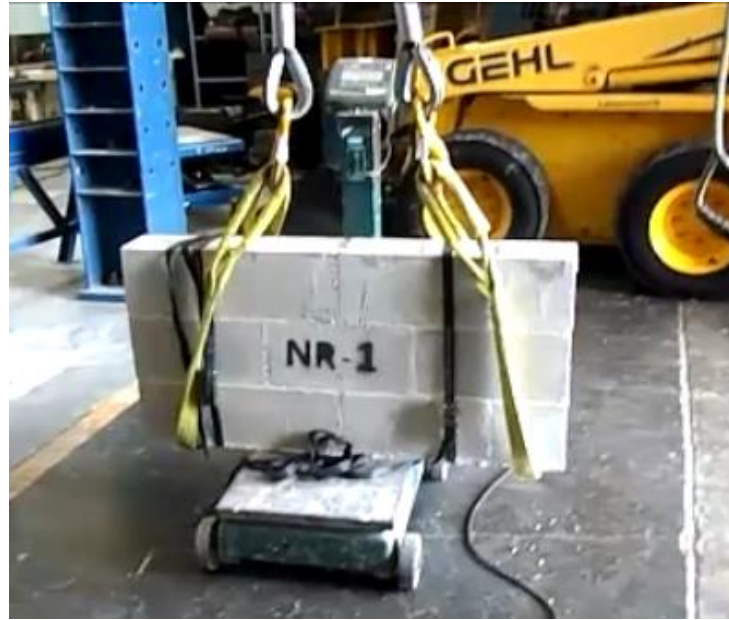
Figura 24. Medición del peso propio de los muretes
