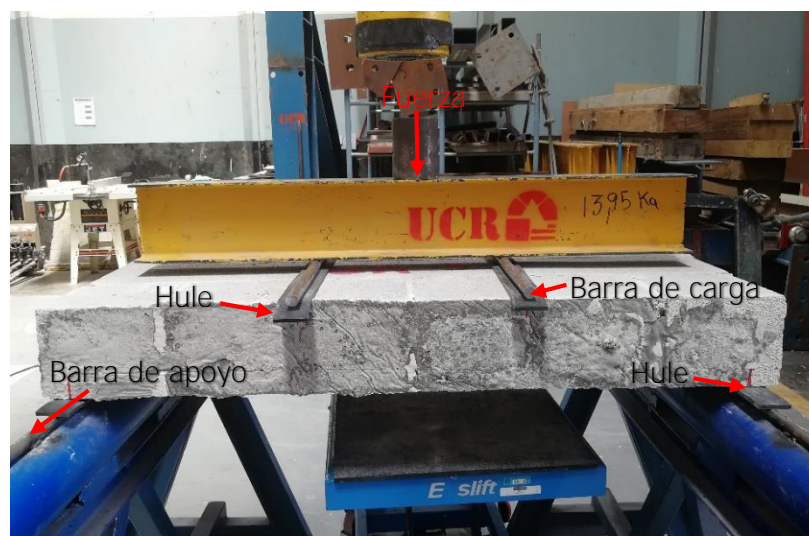
Figura 31. Colocación del murete en el dispositivo de carga
