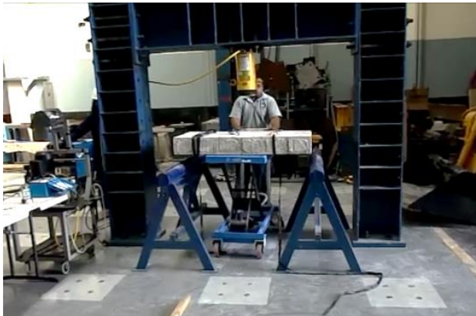
Figura 29. Colocación del murete sobre la grúa móvil
