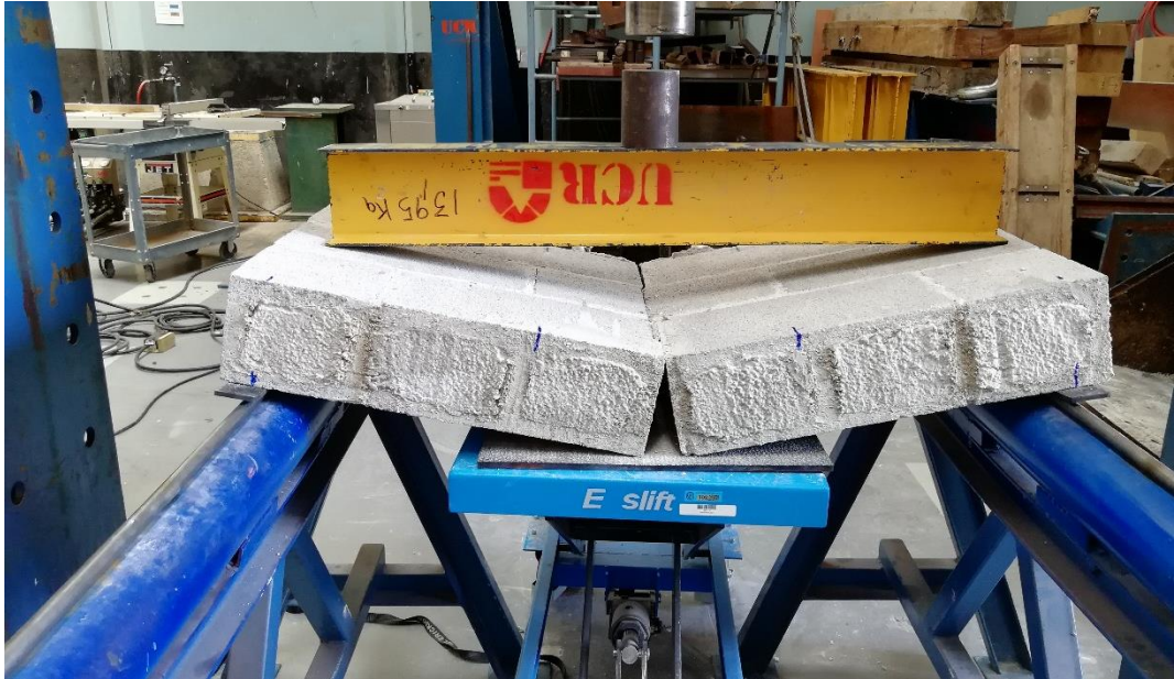
Figura 32. Modo de falla observado en todos los muretes
