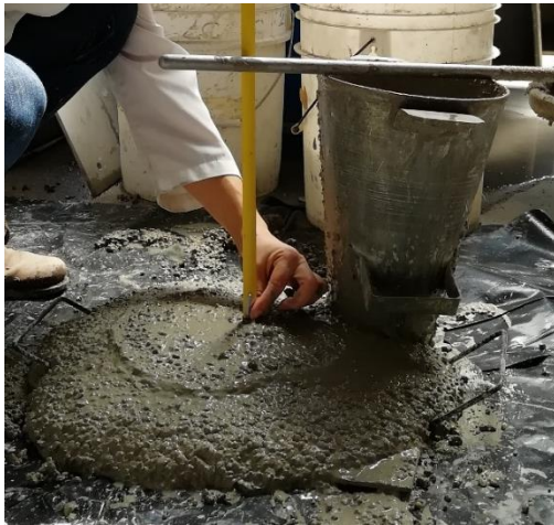
Figura 20. Prueba de revenimiento
