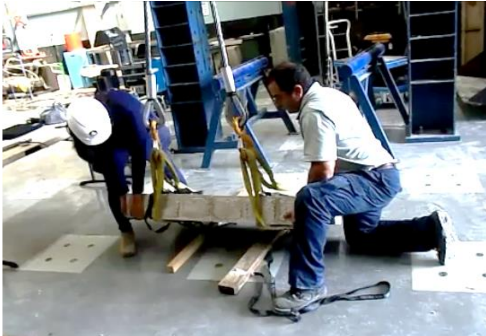
Figura 26. Inclinación del murete hacia la posición horizontal
