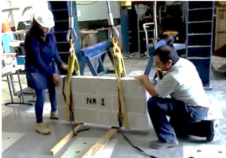
Figura 25. Colocación de los muretes sobre piezas de madera para llevarlos a la posición horizontal
