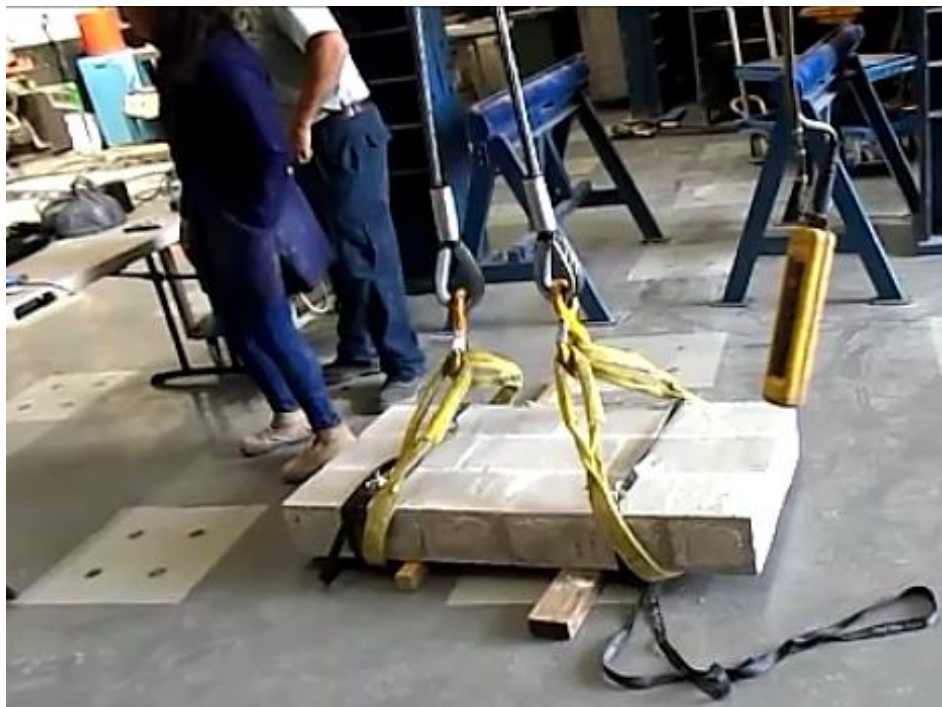
Figura 27. Murete en posición horizontal
