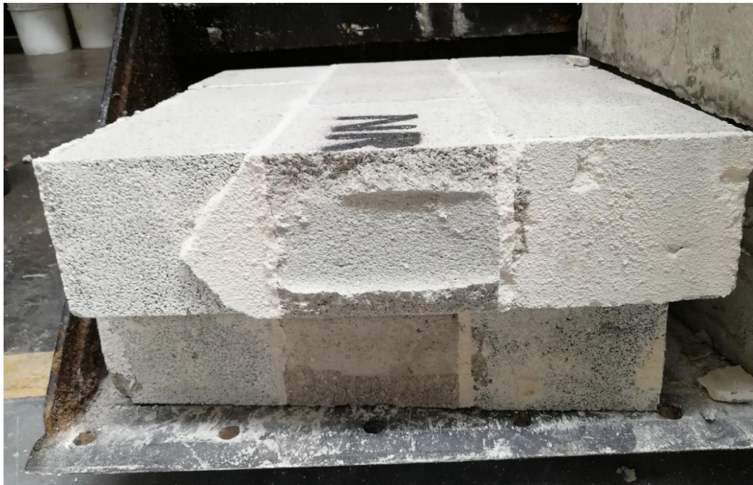
Figura 33. Sección transversal del plano de falla
