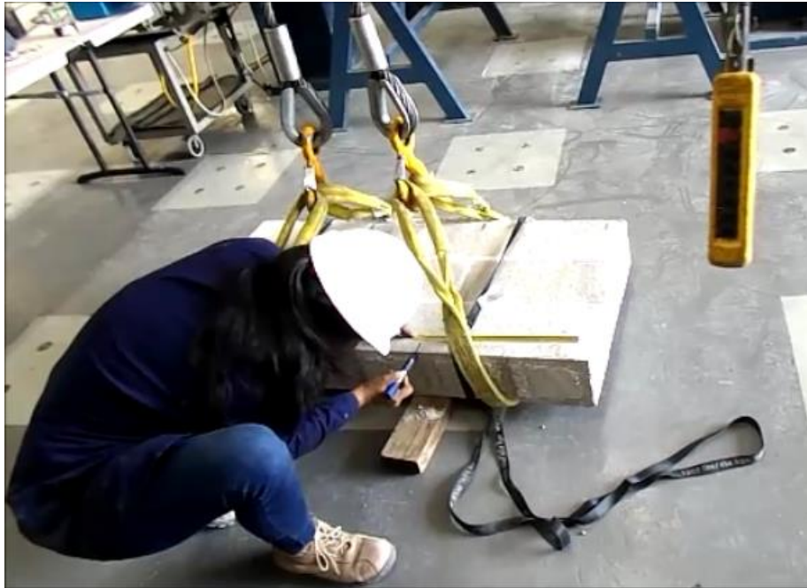
Figura 28. Señalamiento de los puntos de apoyo y puntos de carga
