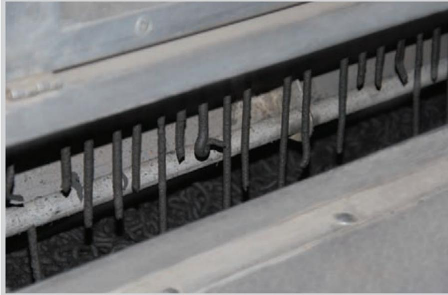
**Figura 6.6.** Ejemplo de extrusor de lodos considerado para el presente diseño del sistema de secado de lodos con bandas a mediana de temperatura (Redco Sludge Technologies, 2014)
