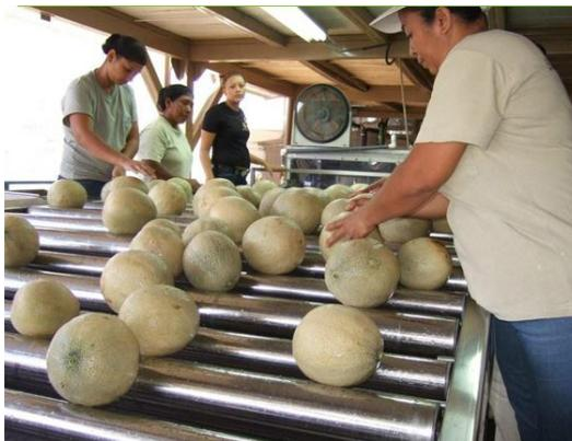
**Figura 1.4.** Banda de clasificación del melón.
