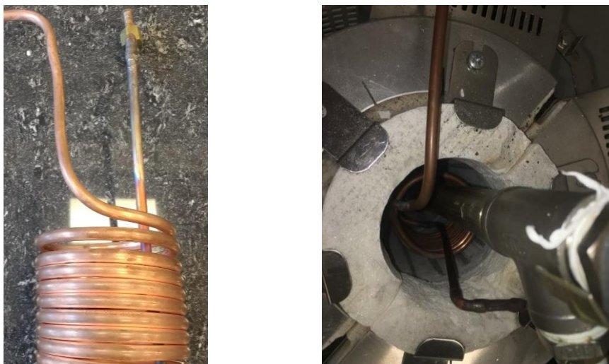
Figura 5.7 Serpentín de tubo flexible de cobre utilizado en el sistema de reacción
