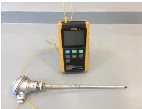
Figura 5.5 Termopar tipo K utilizado en el sistema
