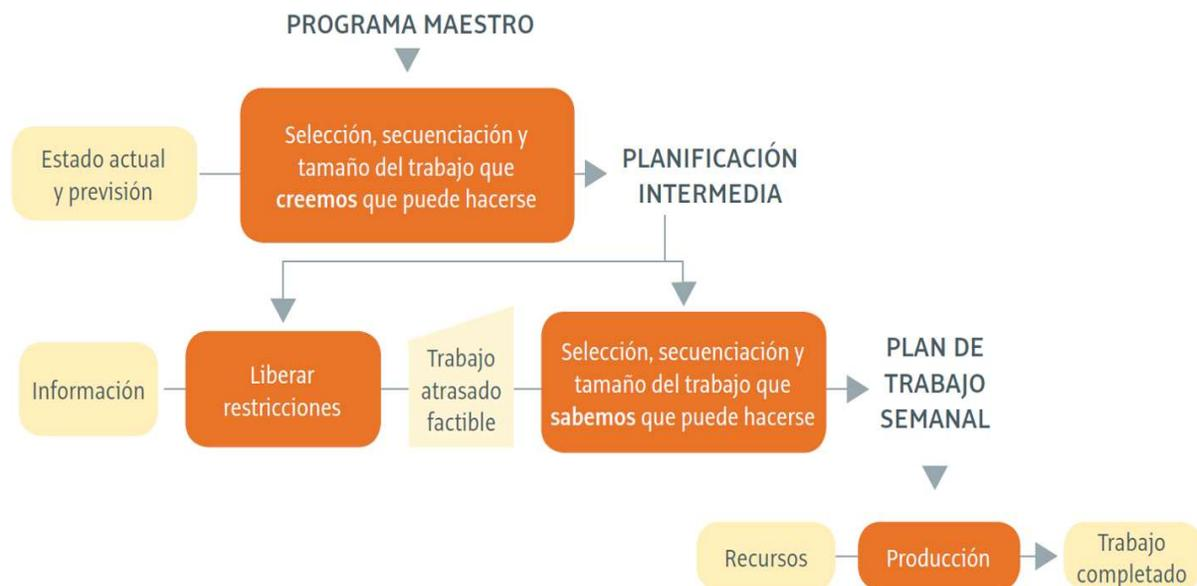
**Figura 14. Esquema del proceso de planificación mediante el Sistema del último Planificador**
