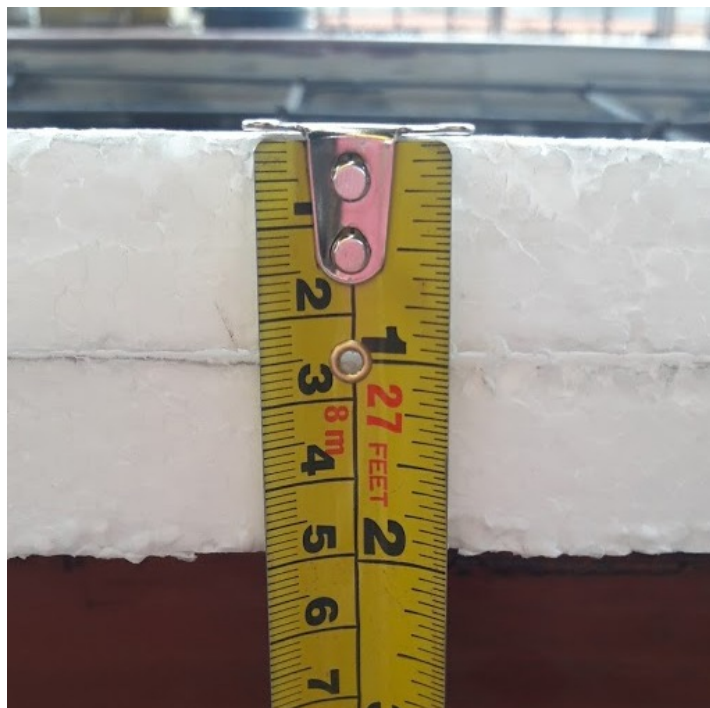
Figura 10. Láminas de poliestireno expandido unidas para formar diferencia de espesor
