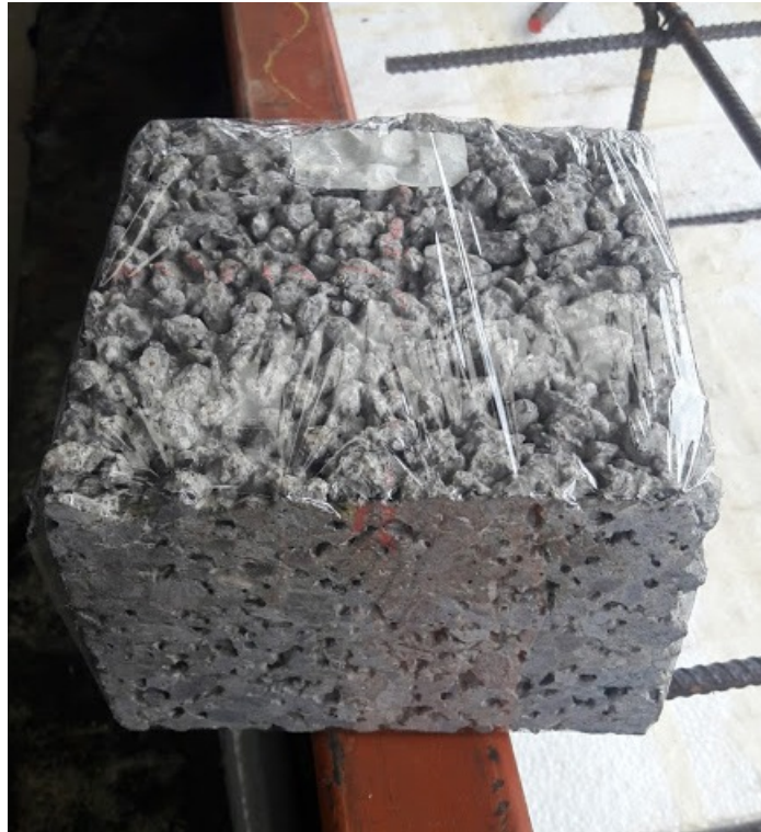
Figura 9. Bloque de concreto permeable cubierto con plástico
