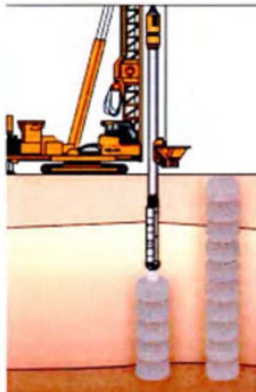
Figura 5. Columna de grava por vibrosustitución.
