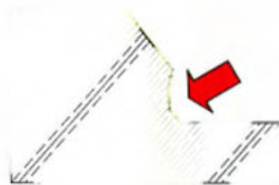
Figura 1. Sobre excavación en la base.
