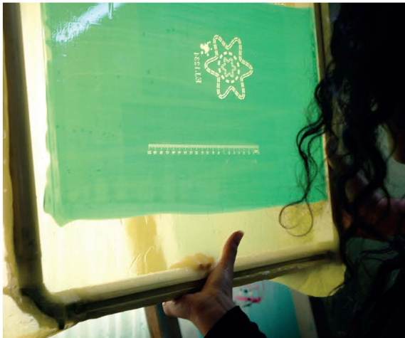
Verificación de la correcta exposición y revelado, comparando el detalle contra el original
