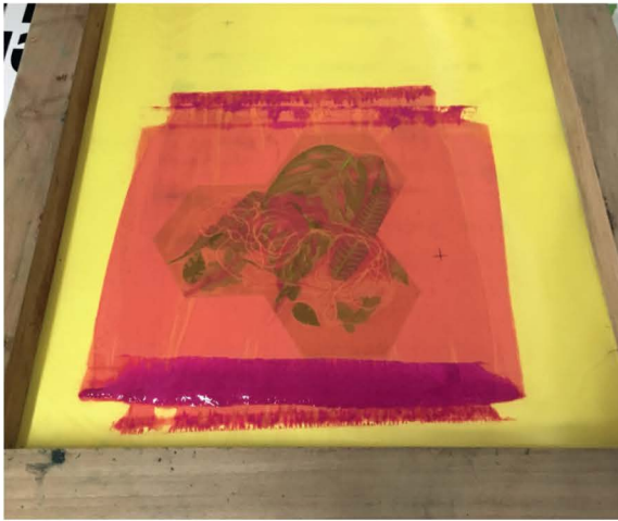
Aplicación de tinta con rasero o “squeegee” sobre la malla 120H
