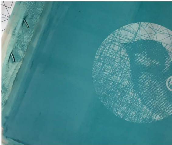
Detalle de marco de madera con malla blanca 100 hilos [abierta] y fijada con grapas sobre marco de madera para tintas base de agua para textil
