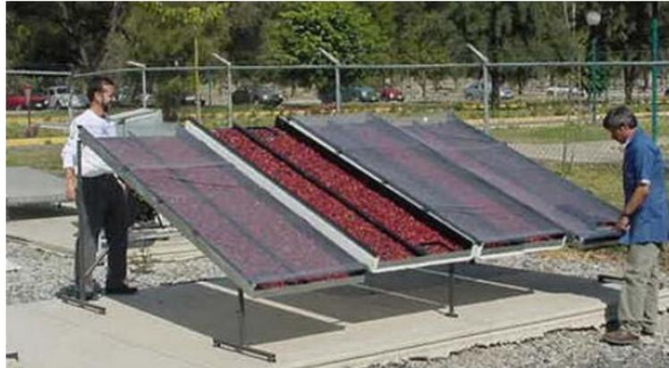
**Figura 2.22.** Secador solar directo. (Montiel, 2004).
