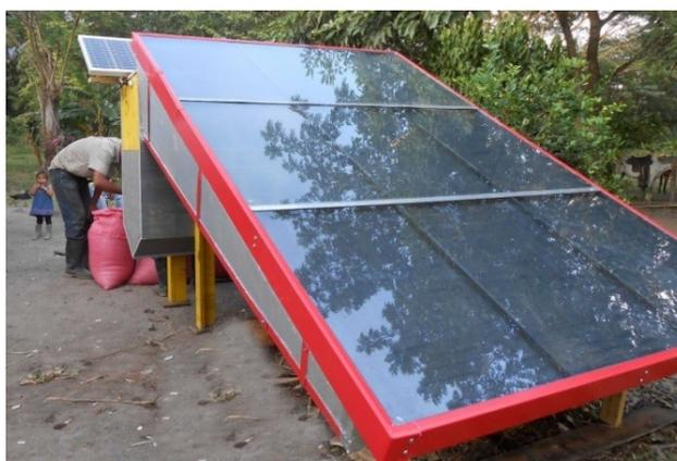
**Figura 2.25.** Colector quintuple utilizado por la empresa CONA Solar. (Sandoval, 2013)
