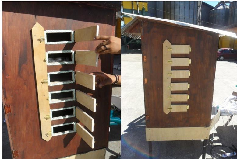
**Figura 4.4.** Compuertas para la toma de muestras, abiertas y cerradas. Fuente: Julián Molina.
