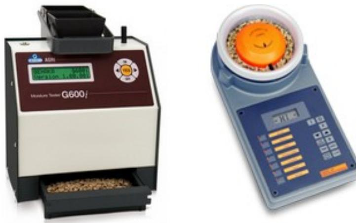
**Figura 5.2.** Medidores de humedad utilizados en las pruebas de determinación de Humedad base húmeda café pergamino y oro.
