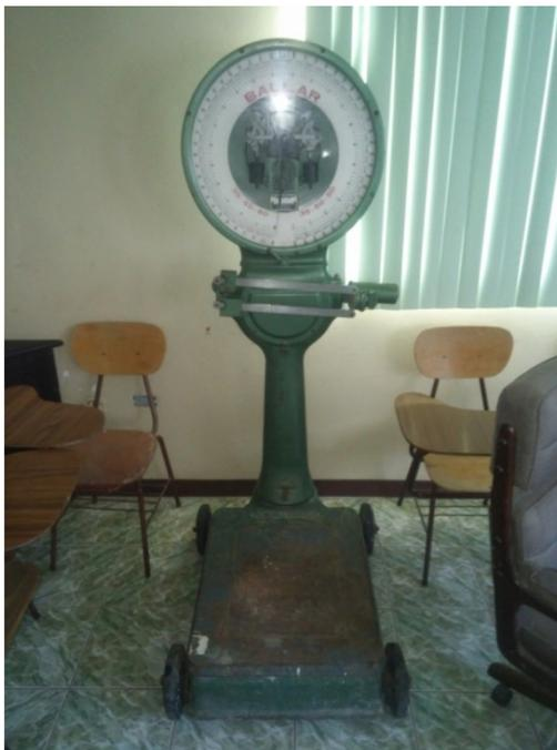
**Figura 5.6.** Romana utilizada para pesar la masa de café utilizada en cada una de las bandejas durante las pruebas de secado. Fuente Julián Molina.
