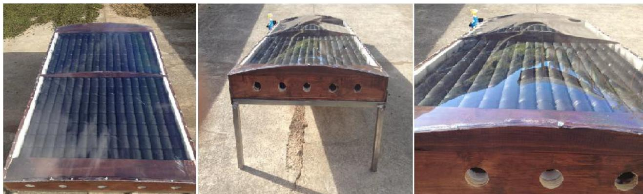
**Figura 2.24.** Colector solar construido, con salidas de aire a los lados. (Mora, 2013)
