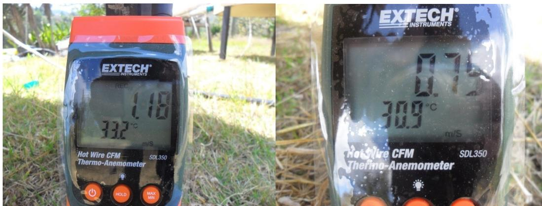
**Figura 6.3.** Fotografías de termooanemómetros de hilo caliente durante la realización de una prueba de secado de café, para el secador tico y canadiense respectivamente.
