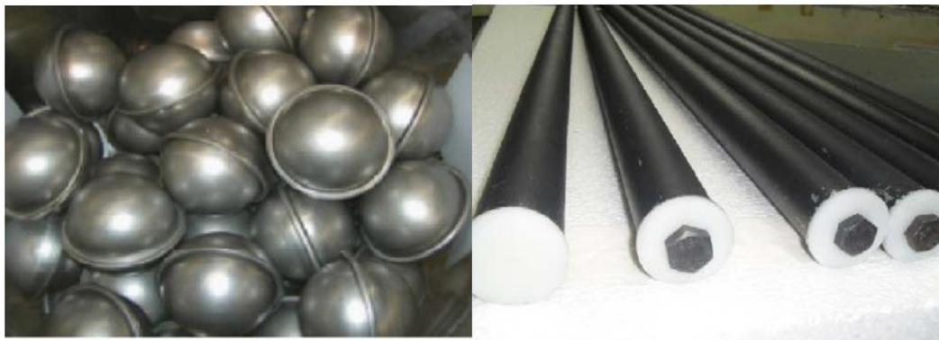
**Figura 2.18.** Materiales para el almacenamiento de calor con cambio de fase. (Mahmud, 2011)
