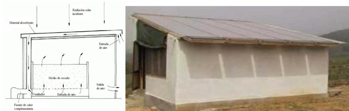
**Figura 2.15.** Ejemplo de Secador solar de tipo casa. [ CITATION Wer \l 5130 ]
