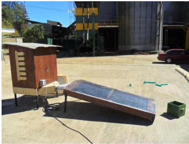
**Figura 2.21.** Secador solar indirecto de circulación forzada. (Fuente. Julián Molina).
