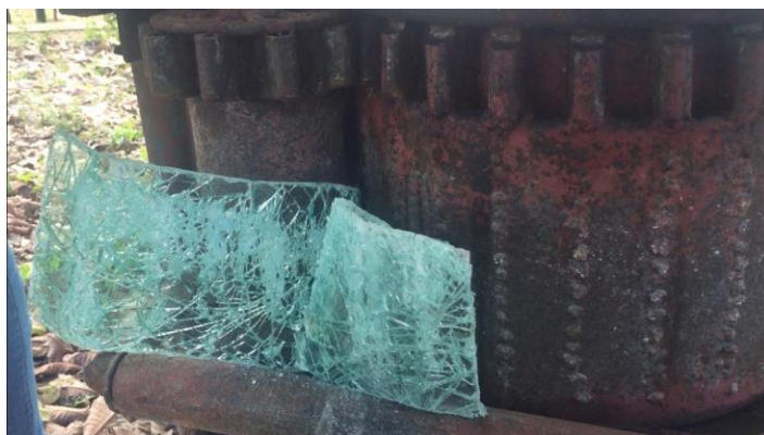
Figura 27. Láminas de parabrisas pasando por el trapiche, tercera prueba.
