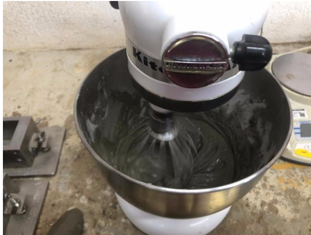
Figura 39. Preparación de mezcla de vidrio con concreto.
