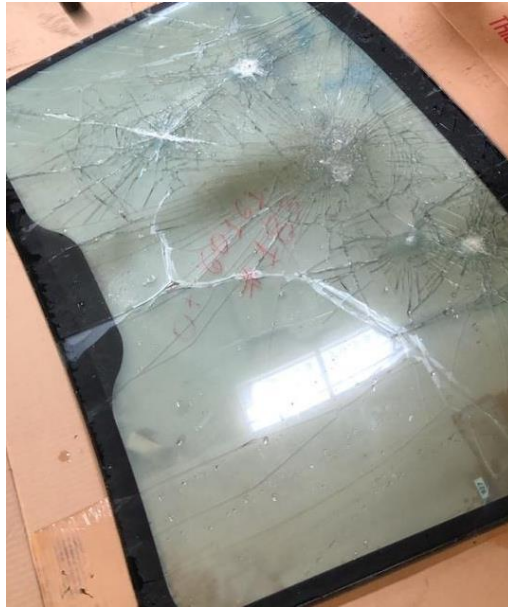
Figura 21. Estado del parabrisas después de 4 golpes, segunda prueba.
