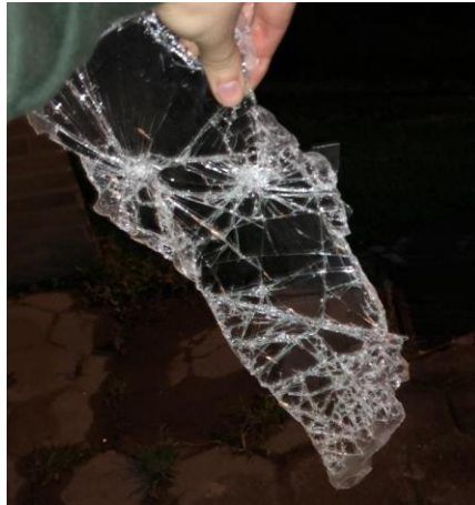
Figura 19. Trozo de vidrio laminado quebrado, primera prueba.
