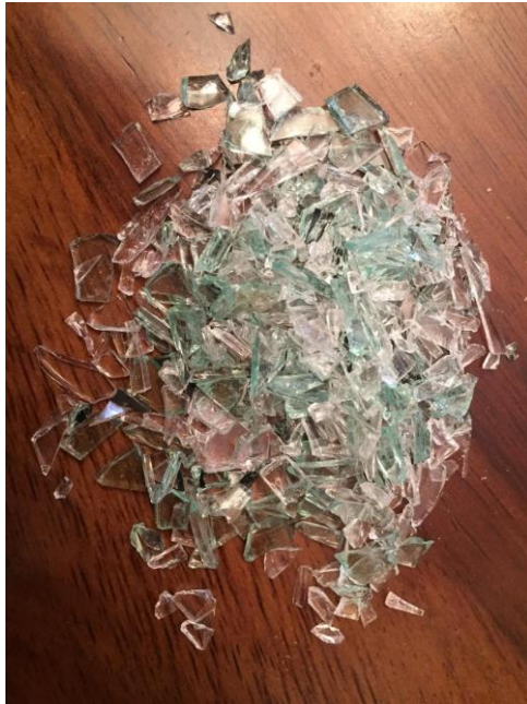
Figura 23. Vidrio quebrado y desprendido del PVB, segunda prueba.
