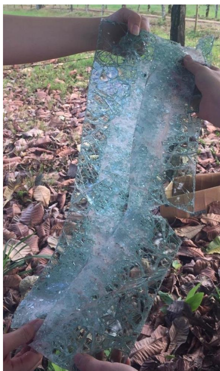
Figura 28. Láminas de parabrisas quebradas después de pasar por el trapiche, tercera prueba.
