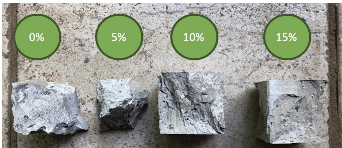
Figura 41. Resultados de la prueba de resistencia a los cubos según el porcentaje de vidrio en cada uno estos.
