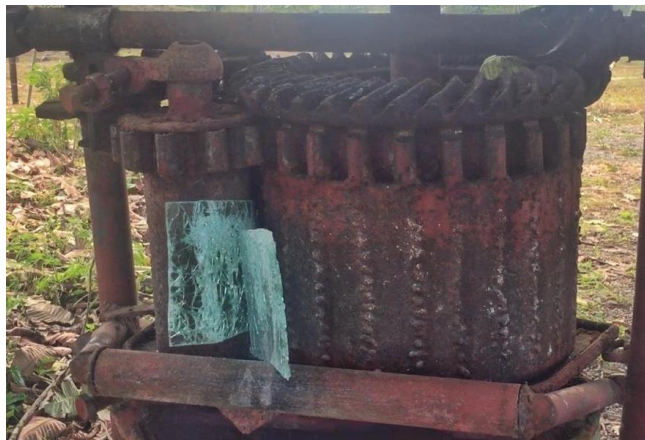
Figura 26. Láminas de parabrisas pasando por el trapiche, tercera prueba.
