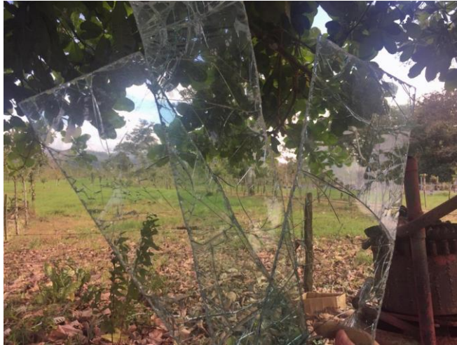
Figura 25. Láminas de parabrisas cortadas con esmeril, tercera prueba.
