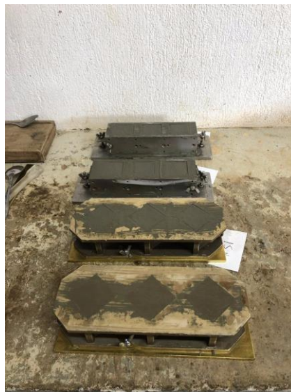
Figura 40. Preparación de cubos de concreto.
