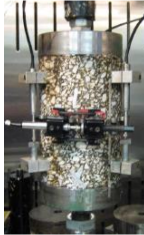
Figura 2-10. Configuración del ensayo de fatiga a tensión directa
