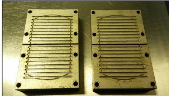
Figura 2-19. Bases metálicas para pegar especímenes del ensayo Overlay
