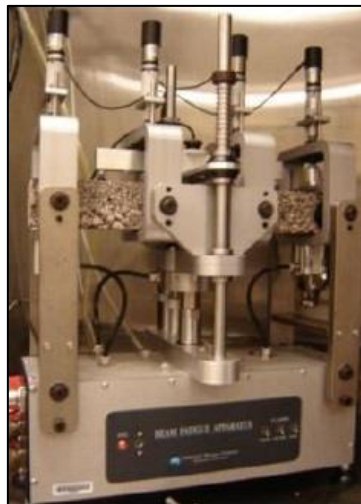
Figura 2-6. Ensayo de viga a flexión en cuatro puntos
