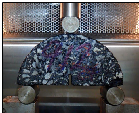
Figura 3-9. Configuración de los ensayos RSCB y SCB
