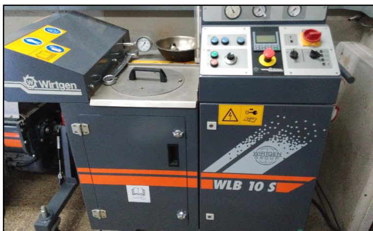
Figura 3. 13. Planta de asfalto, modelo WLB 10 S, ubicada en el Laboratorio de Mezclas Bituminosas del LanammeUCR
