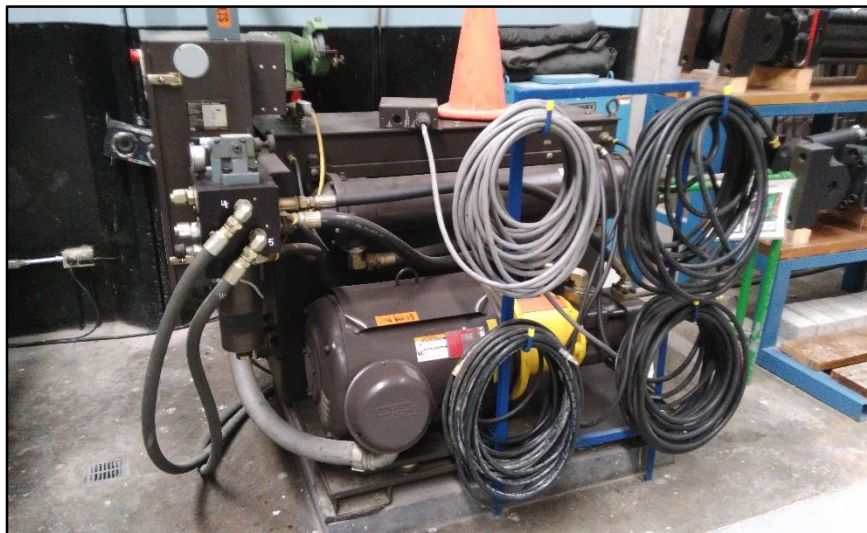
Figura 3. 10. Bomba hidráulica, modelo 326 TC, ubicada en el Laboratorio de Modelos Estructurales a Escala Natural del LanammeUCR
