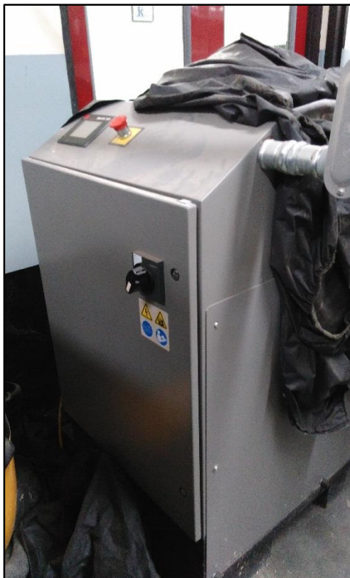
Figura 3. 12. Unidad de potencia hidráulica, modelo 505.11-G2, ubicada en el Laboratorio de Modelos Estructurales a Escala Natural del LanammeUCR
