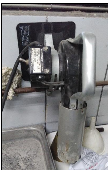
Figura 3. 14. Soplador de aire caliente, modelo AH-751, ubicado en el Laboratorio de Concreto y Agregados del LanammeUCR
