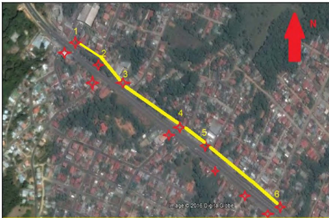
Figura 6.53. Accesos que pueden unificarse debido a la existencia de una vía paralela a la ruta principal
