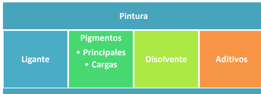
Figura 1.2 Esquema general de la composición de una pintura.
