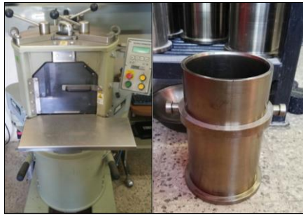
Figura 3. SGC y molde empleado para la compactación de la mezcla.
