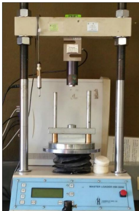
Figura 15. Equipo de falla para el ensayo de RRTD.
