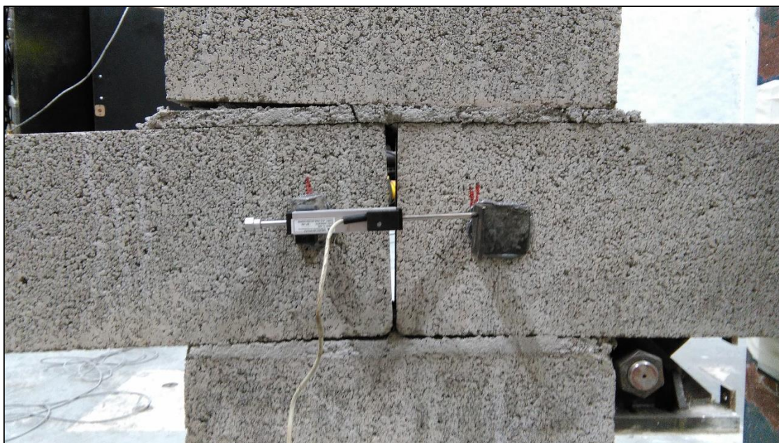
Figura 25. Cruz de mampostería después de ser fallada
