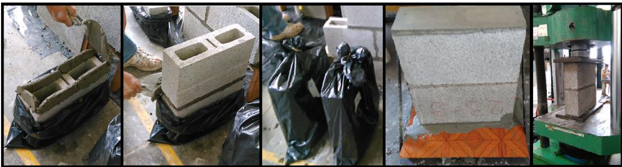
Figura 14. Proceso de construcción, almacenamiento y falla de los prismas de mampostería
