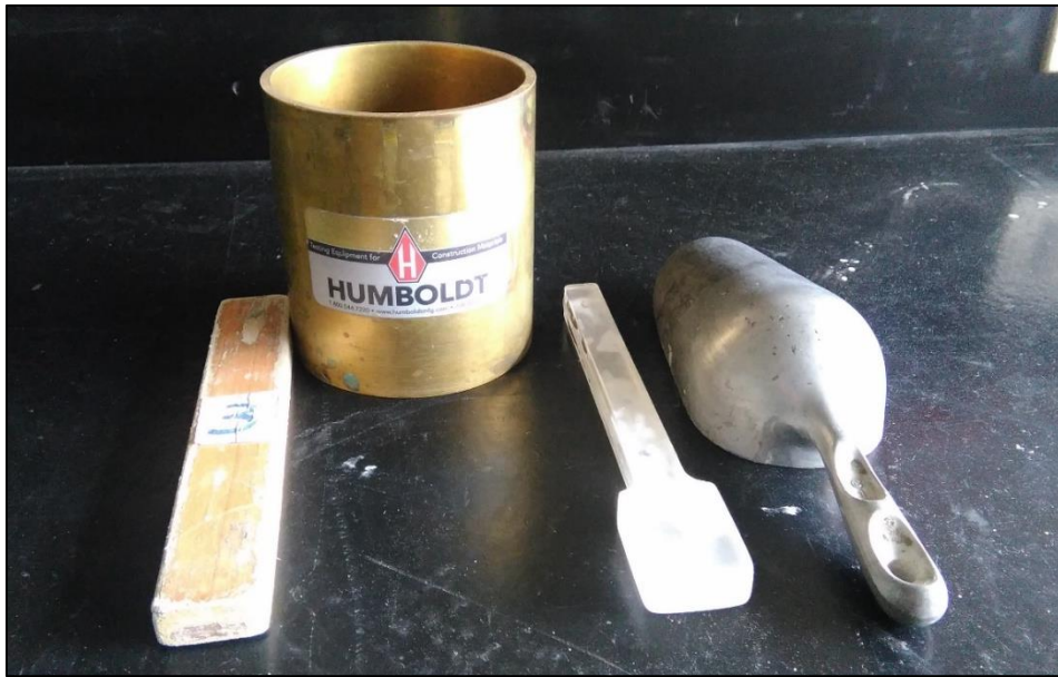
Figura 9. Equipo utilizado para la prueba de contenido de aire en el mortero
