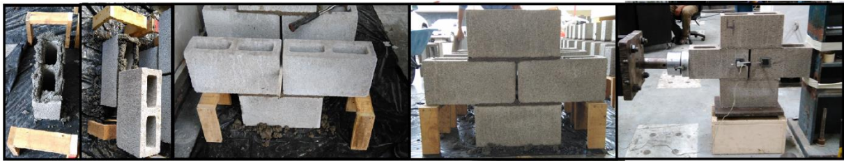
Figura 16. Proceso de fabricación y falla de las cruces de mampostería
