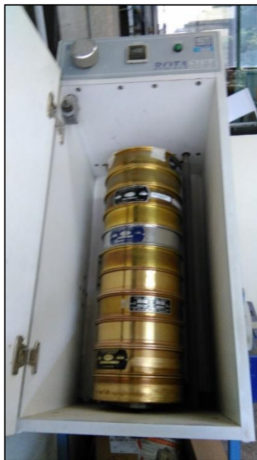
Figura 5. Mallas apiladas verticalmente, colocadas en el agitador mecánico para análisis granulométrico
