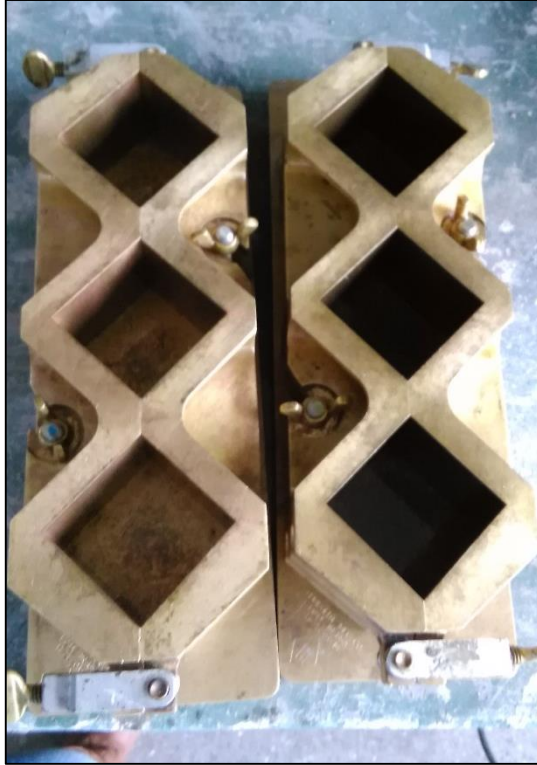
Figura 12. Moldes utilizados para la elaboración de los cubos de mortero de 50 mm
