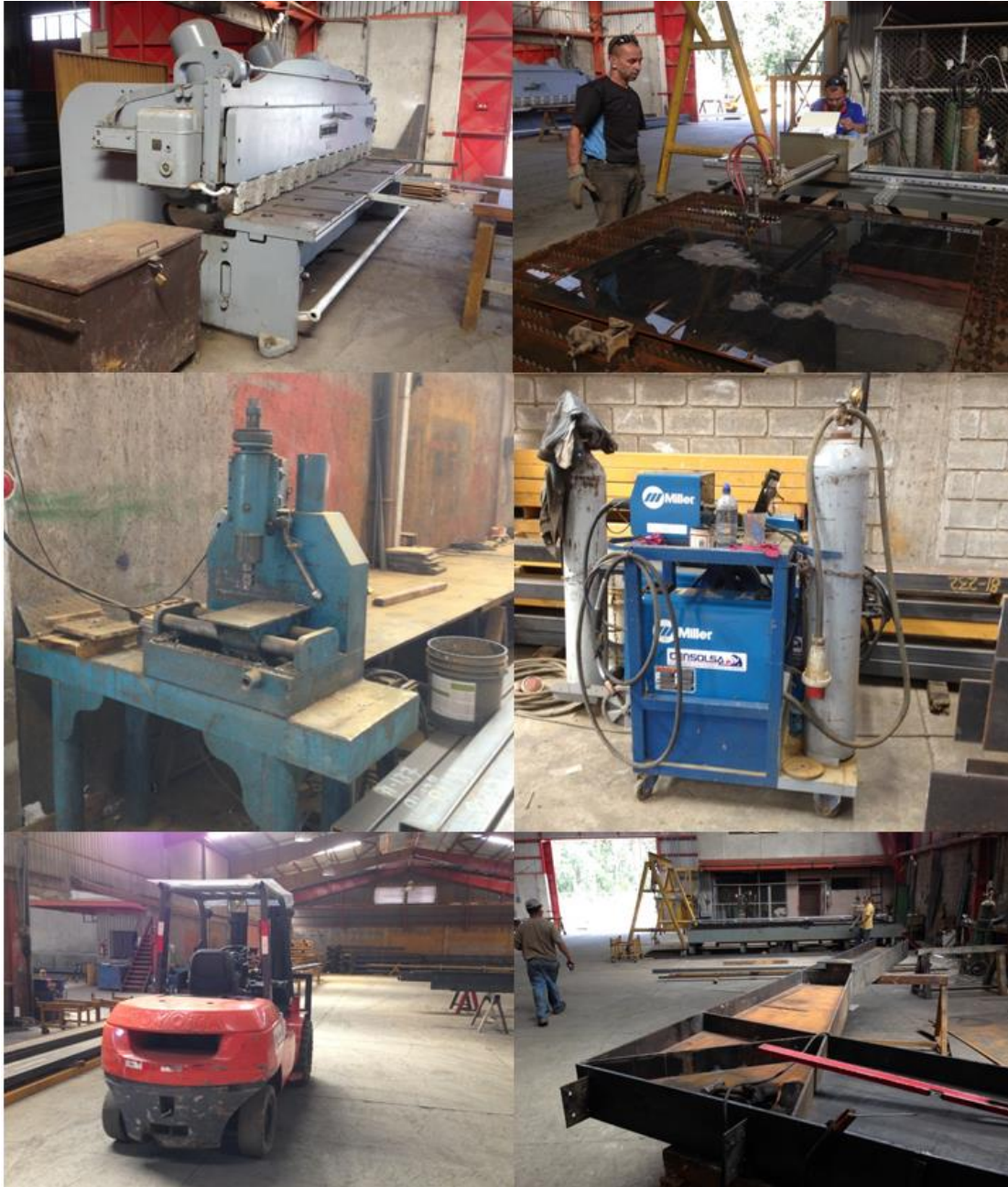
Figura 4.1. Equipos utilizados, guillotina (superior izquierda), cortadora CNC (superior derecha), taladro magnético (intermedia izquierda), soldadora tipo Mig (intermedia derecha), montacargas (inferior izquierda), equipo manual (inferior derecha).
